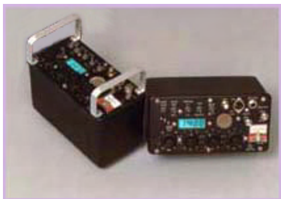
Radio-ontvanger R2000 (Advanced Telemetry Systems). De ingevoerde frequenties worden tijdens het scannen afgebeeld op de digitale display. Uitwijkingen van de naald geven een visuele ondersteuning voor het bepalen van minimum- of maximumsignaal van de zender.
