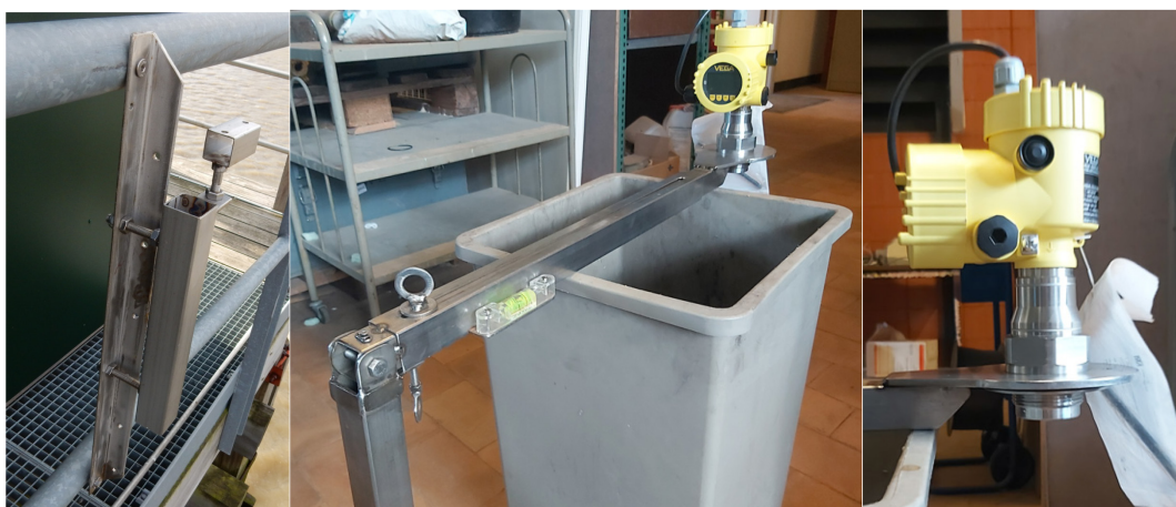
Figuur 2 – meetpost Hemiksem (zes28a) met zicht op de vaste houder (foto links) van waaruit de nieuwe controlemetingen met mobiele radar (foto midden en rechts) voortaan gebeuren.
