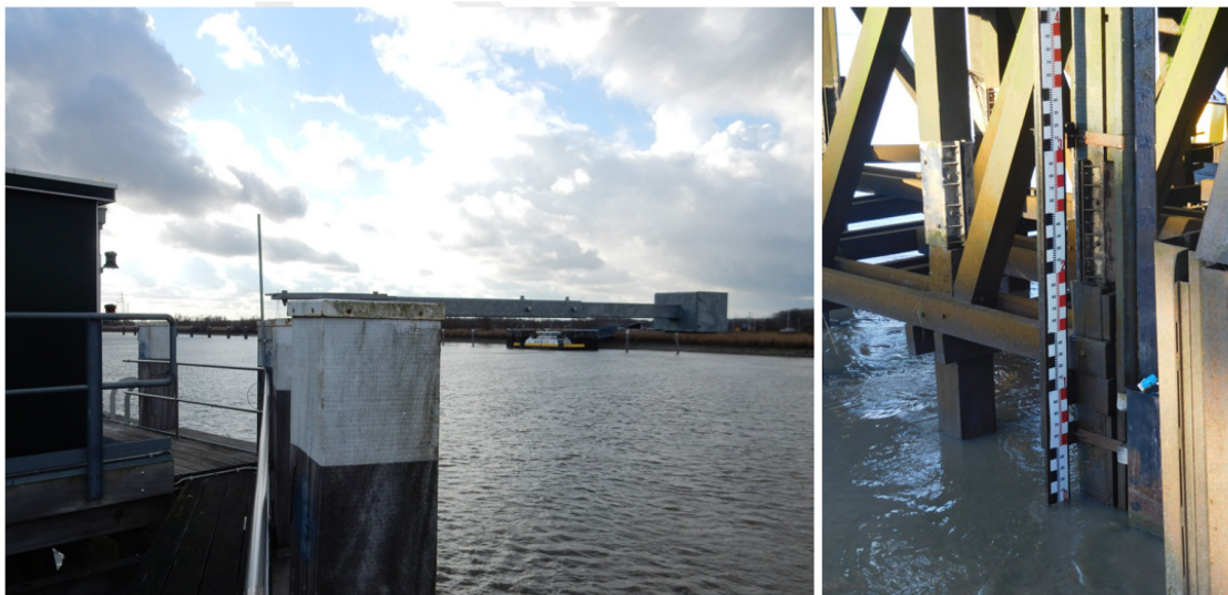
Figuur 1 – Meetpost Hemiksem (zes28a) met links zicht op de vrijstaande OTT radar aan de metalen arm en rechts zicht op de peilschaal die in 2013 opnieuw werd ingemeten met RTK-gps
