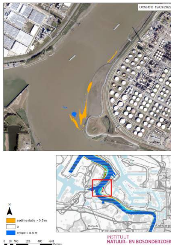
Figuur 14.13: Zone met sedimentatie en afwezigheid erosie (periode 2021-2022) in de ondiep water en laag slik zone ter hoogte van het Fort Filip.
