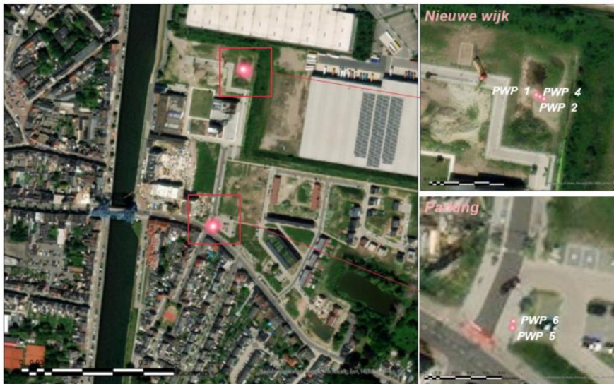
Figuur 6: Willebroek, boringen en peilbuizen geplaatst i.k.v. de uitloogstudie
