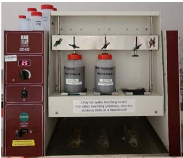
Figuur 12: Foto van de labo-opstelling gebruikt voor het uitvoeren van de schudtest
