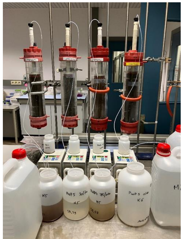
Figuur 13: Foto van de labo-opstelling gebruikt voor het uitvoeren van de kolomproeven
