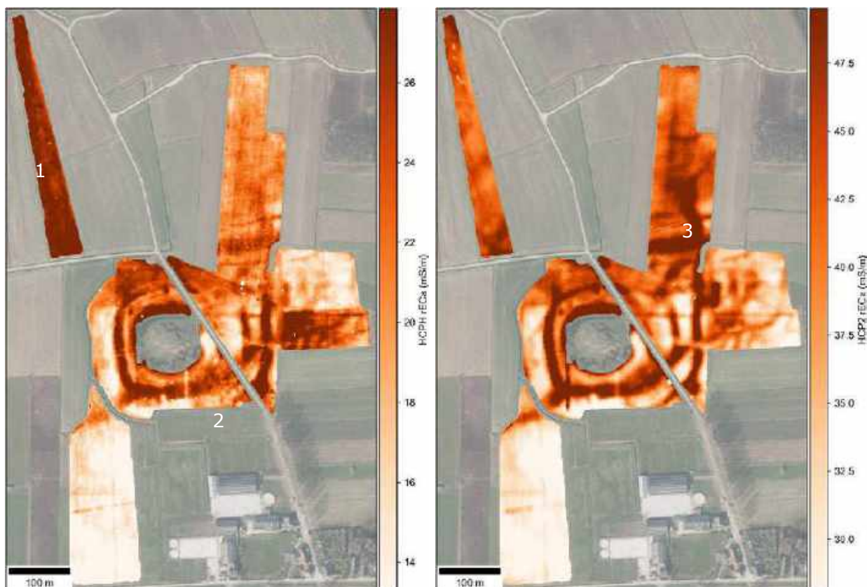
Figuur 277: Overzicht van de ECa data met links de gegevens van de 0.5 m HCP spoelconfiguratie (representatief voor een diepte tot ca. 0.8 m onder het maaiveld), en rechts deze van de 2 m HCP spoelconfiguratie (representatief voor een diepte tot ca. 3.2 m onder het maaiveld).
