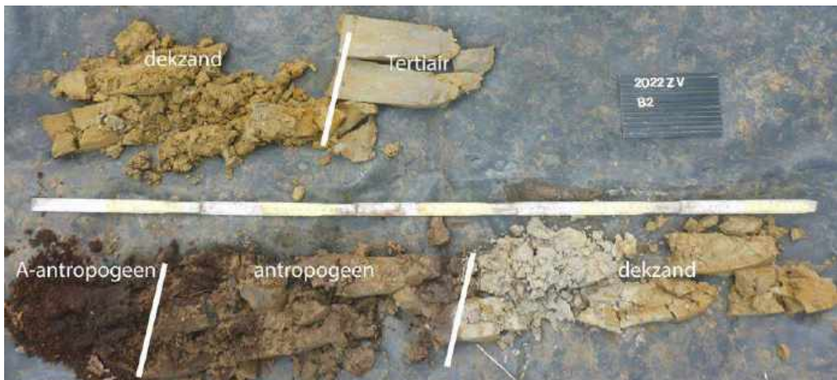
Figuur 40: Boring B2 Zinckval
