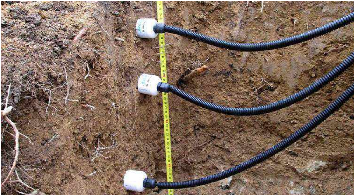
Figuur 22: Voorbeeld van in-situ geofysische sensoren die toelaten continue variaties in onder meer elektrische geleidbaarheid en permittiviteit te monitoren (© 2020. BOKU, University of Natural Resources and Life Sciences, Vienna)
