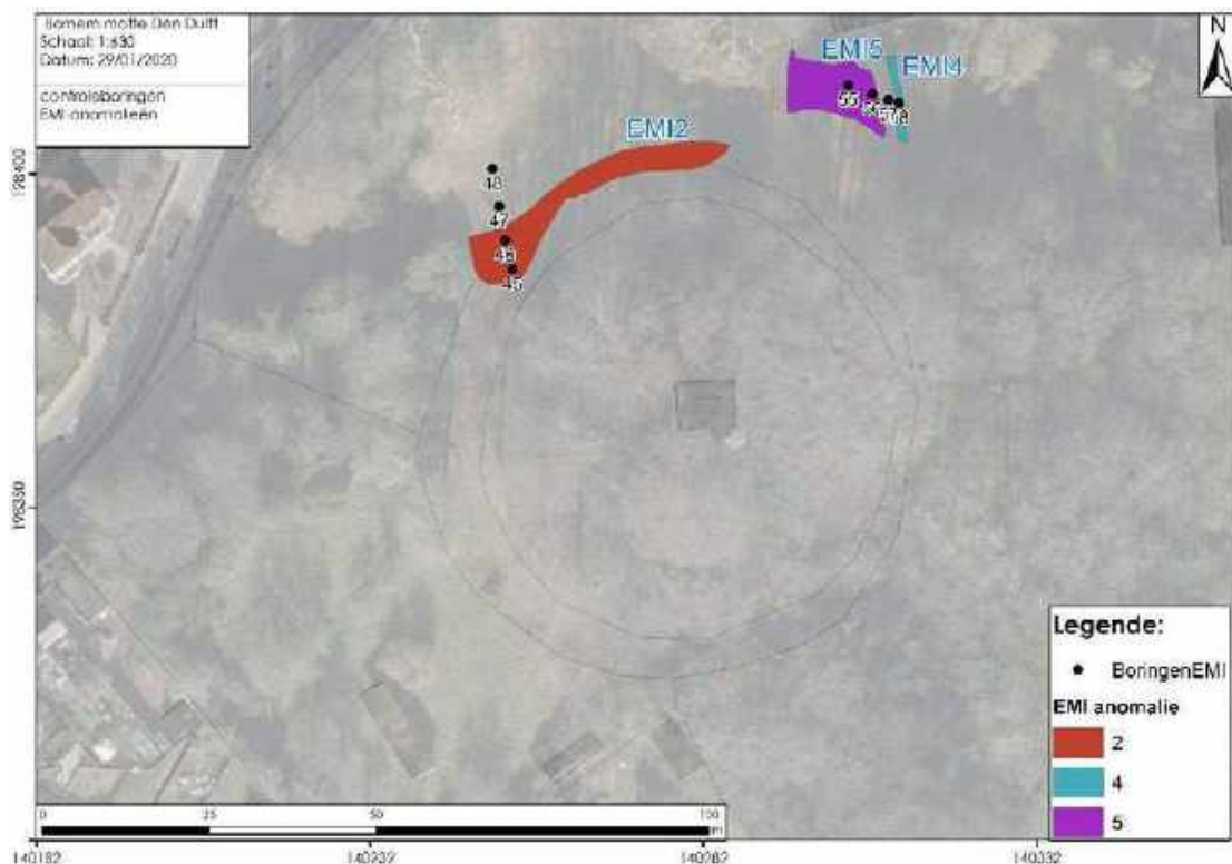
Figuur 326. Controleboringen ter hoogte van EMI-anomalieën (3d soil)
