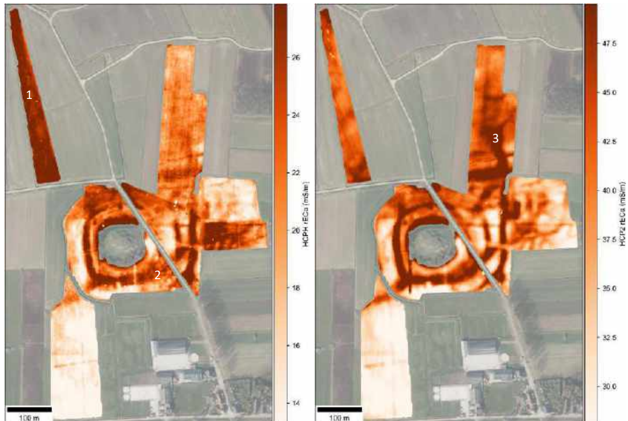
Figuur 7: Overzicht van de E Ca data met links de gegevens van de 0.5 m HCP spoelconfiguratie (representatief voor een diepte tot ca. 0.8 m onder het maaiveld), en rechts deze van de 2 m HCP spoelconfiguratie (representatief voor een diepte tot ca. 3.2 m onder het maaiveld).
