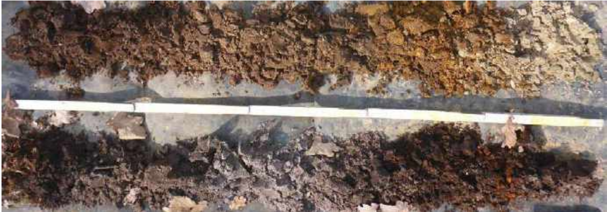
Figuur 526: boring B9 toont een podzol met goed ontwikkelde E-horizont. De A-horizont is gering te onderscheiden van de B-horizonten en is ontwikkeld in antropogene afzettingen (GATE archeologie)
