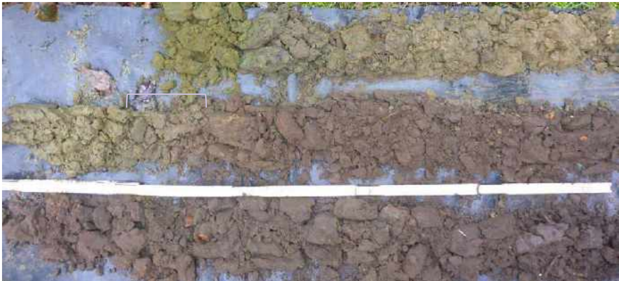
Figuur 423: Boring B6 met de colluviale afzettingen. Op de grens van de colluviale afzettingen naar de afzettingen van de Formatie van Diest is vermoedelijk een restant van een bodem zichtbaar (GATE archeologie)
