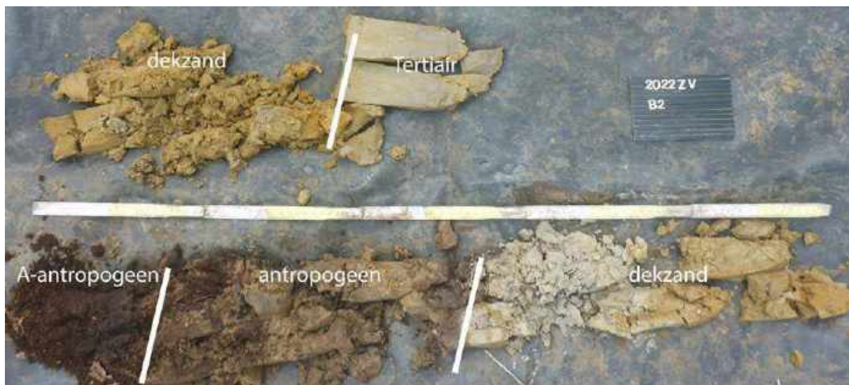
Figuur 236: Boring B2 Zinckval
