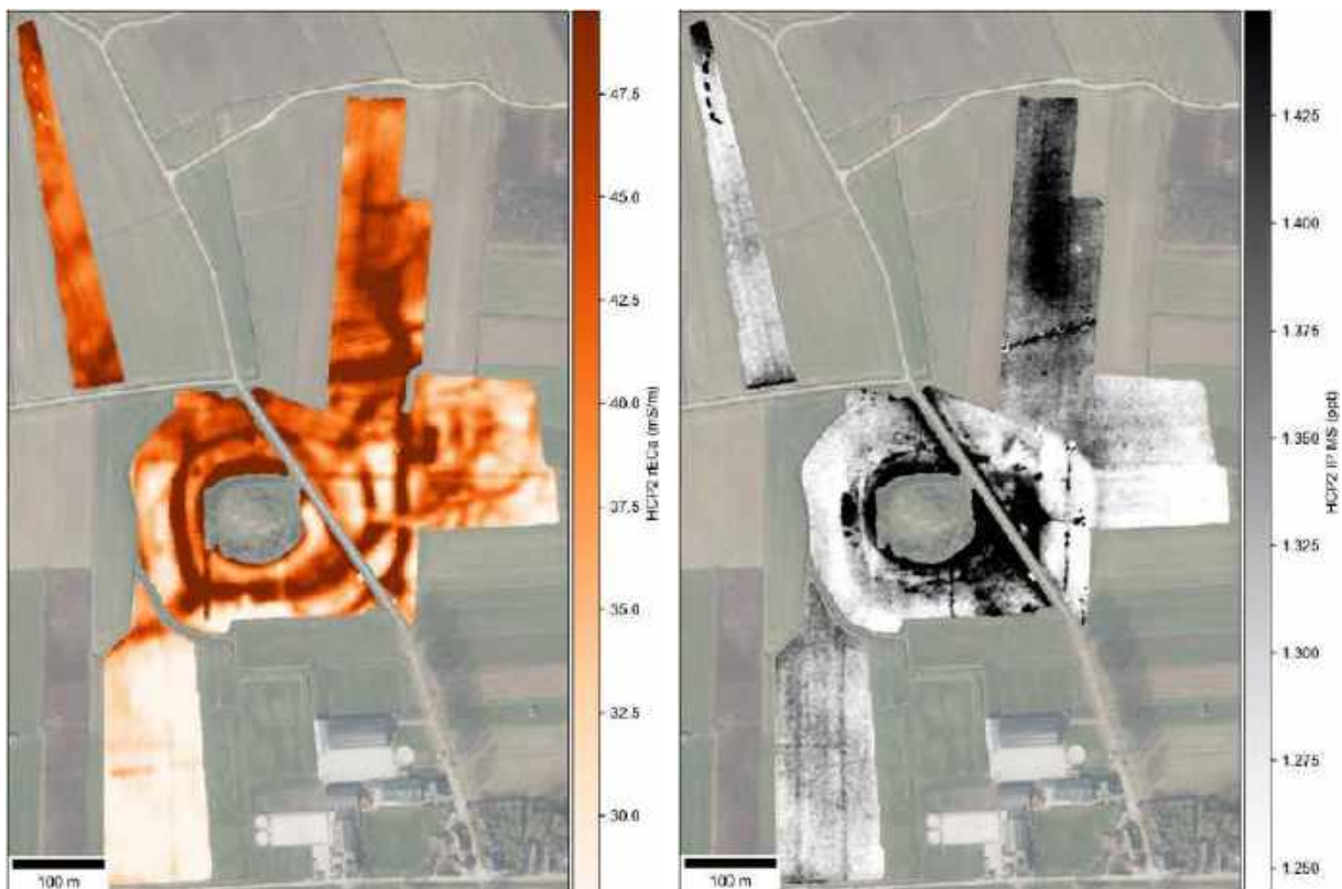
Figuur 6: Overzicht EMI data. Links: Elektrische geleidbaarheidsdata (ECa in mS/m) van de 2 m HCP spoelconfiguratie, representatief voor bodemvolume tot ca. 3 m diepte. Rechts: Magnetische gevoeligheidsdata (IP MS in ppt) van dezelfde spoelconfiguratie.
