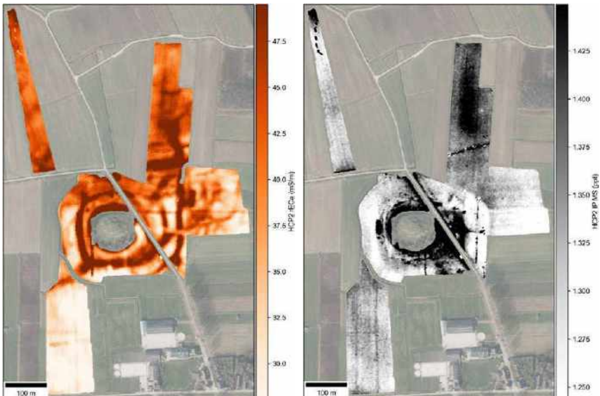
Figuur 276: Overzicht EMI data. Links: Elektrische geleidbaarheidsdata (ECa in mS/m) van de 2 m HCP spoelconfiguratie, representatief voor bodemvolume tot ca. 3 m diepte. Rechts: Magnetische gevoeligheidsdata (IP MS in ppt) van dezelfde spoelconfiguratie.
