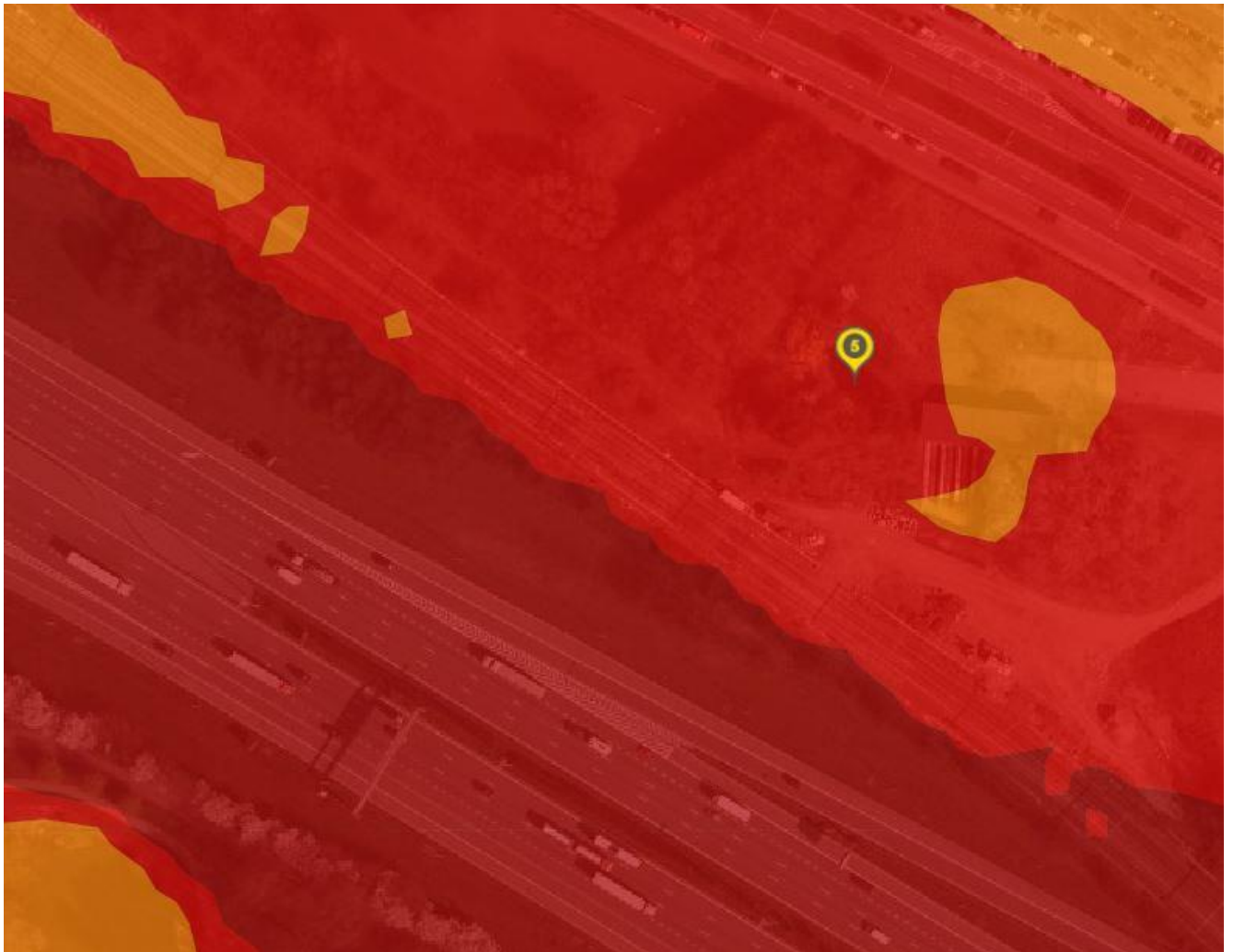
Figuur 4-16 Ligging van MP5 met geluidscontouren van de Vlaamse geluidsbelastingkaart ten gevolge van wegverkeer (referentiejaar 2016) ( L_{den} )
