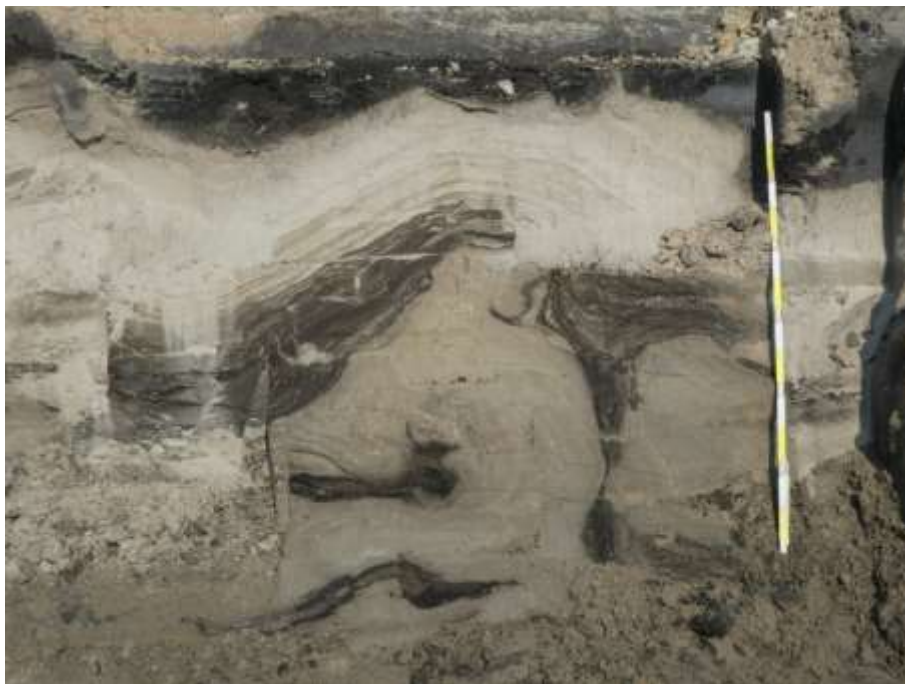
Figuur 30. Detailopname van zand- en veenlagen met cryoturbate structuren, typerend voor het Lid van Beerse (BE). Opnamen in kleigroeve Het Blak-Meergoor te Beerse (Walstra et al., 2020).
