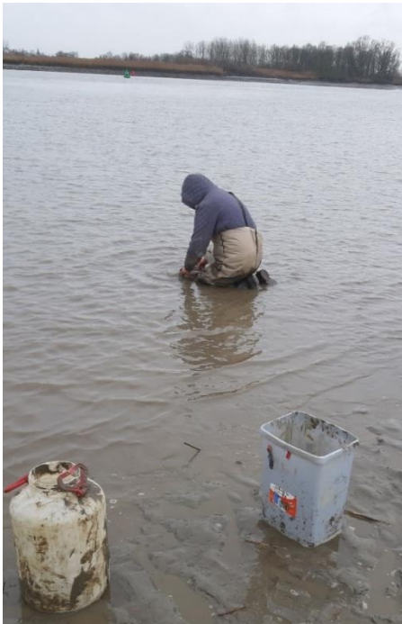
Figuur 6: Staalname van de waterlijn ter hoogte van de Notelaer. De grijze bak werd gebruikt om water te scheppen, de witte ton werd gevuld met dit water. Wanneer de ton gevuld was, werd dit water gezeefd op een zeef van 250µm.
