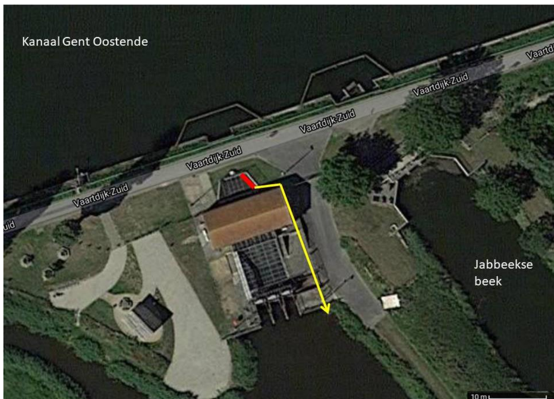
Figuur 21 De positie van de glasaalgoot (rode lijn) ter hoogte van het pompemaal Kwetshage-Paddegat. De gele pijl geeft de geleidingsbuis weer.
