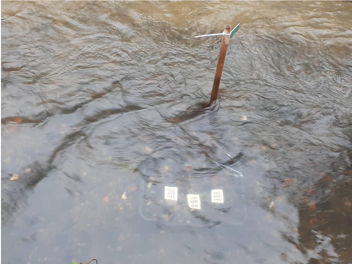
Figuur 61 Per riffle werd een fruitbak gedeeltelijk ingegraven, waarin de 3 Vibertboxen werden geplaatst die elk voorzien zijn van 200 beekforeleitjes. De foto toont ook de houten stok die in het substraat werd geslaan om een idee te krijgen van de anoxie in de bodem (Foto INBO).
