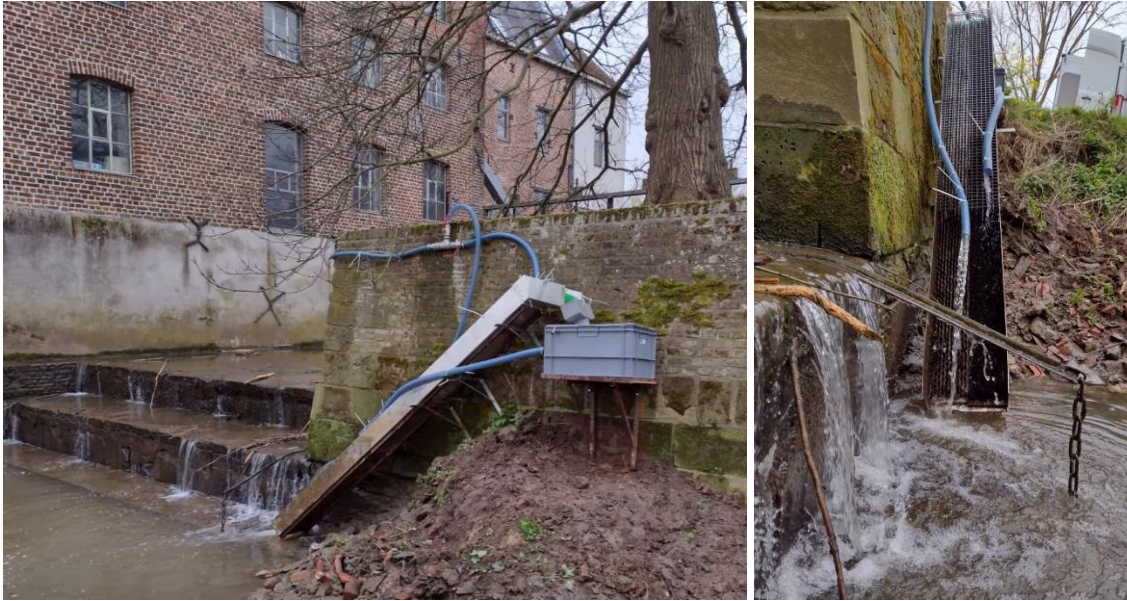
Figuur 29 De experimentele glasaalgoot te Rotselaar was regelmatig, maar beperkt in tijd, niet optrekbaar voor glasaal en elvers.
