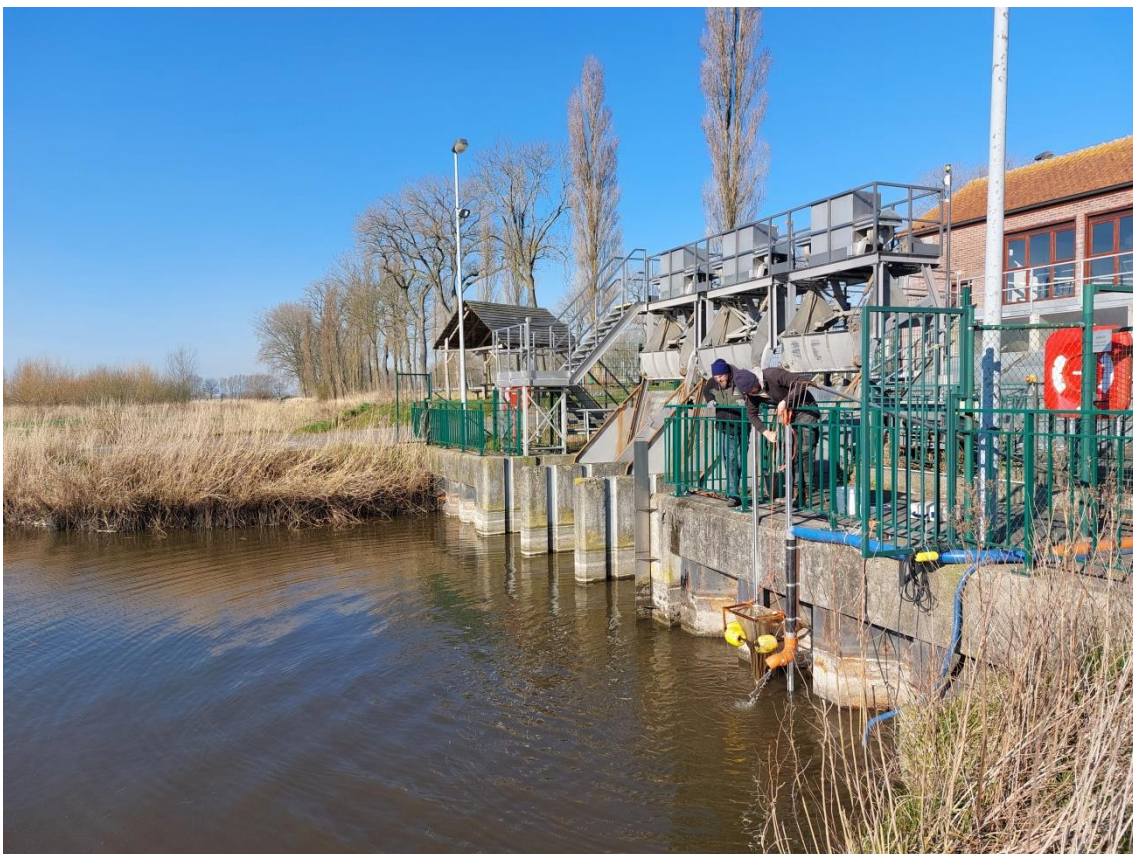
Figuur 23 Hier komt de afvoerbuis uit in de polder. De opvangbak wordt op de foto omhoog getrokken om de vangst te kunnen bekijken.
