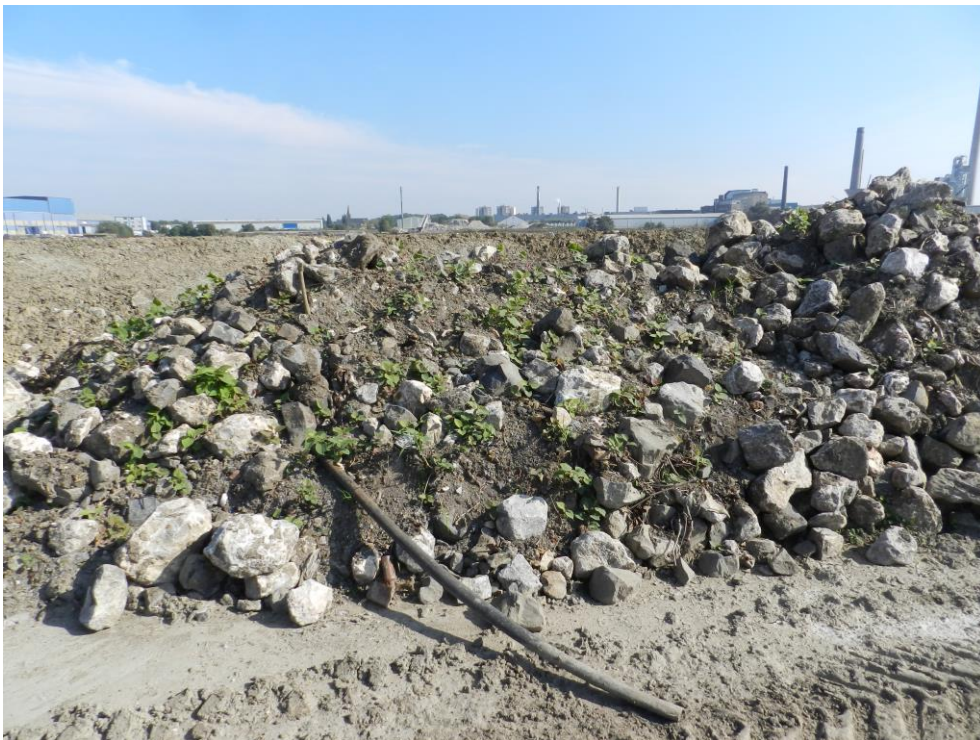
Figuur 70 Bouwmateriaal voor de aanleg van dijken dat besmet is met wortelstokken van Japanse duizendknoop ( Fallopia japonica ). De stengels schieten reeds door. De meeste verspreiding van Japanse duizendknoop gebeurt tegenwoordig door gebruik van besmette grond (02/10/2013).
