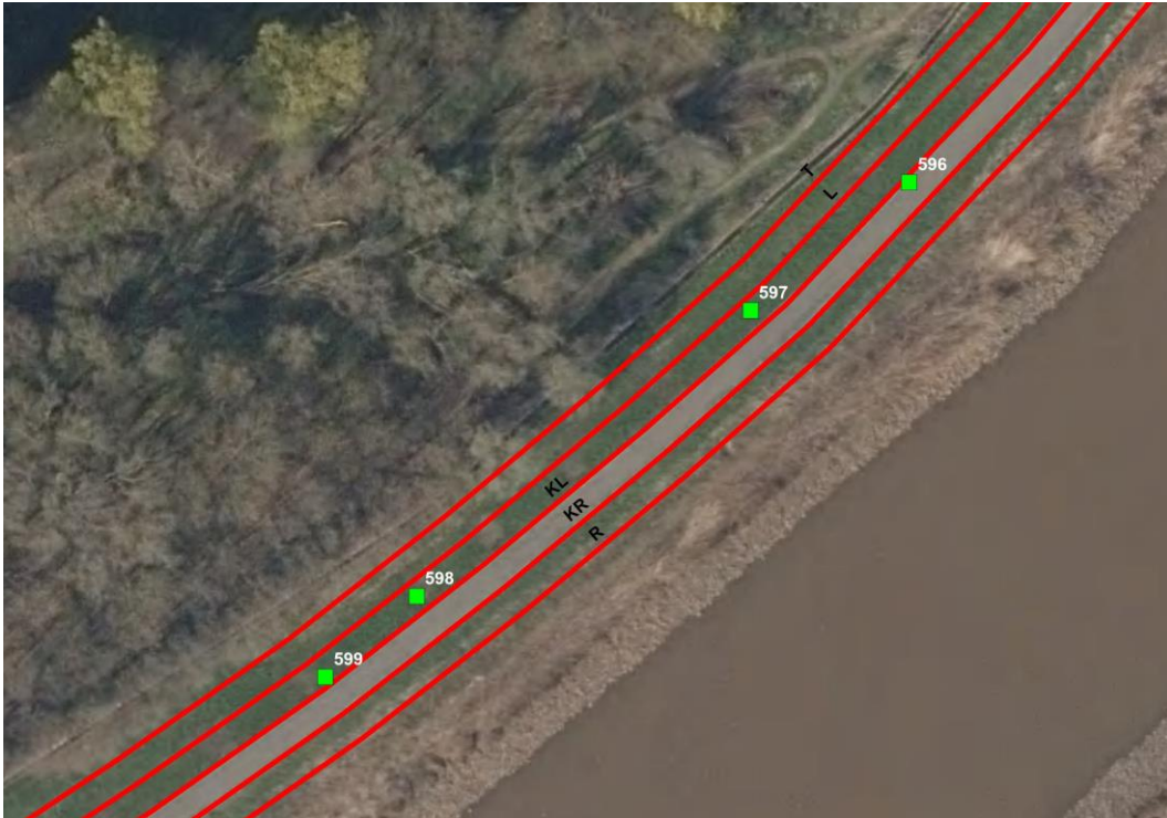
Figuur 54 Voorbeeld van de basiskaart met 5 parallelle lijnen, één voor elke dijkzone (R, KR, KL, L, T), illustratief getekend op de dijk. De groene vierkantjes geven als voorbeeld enkele waypoints weer op grond waarvan homogene vegetatie-eenheden worden onderscheiden.
