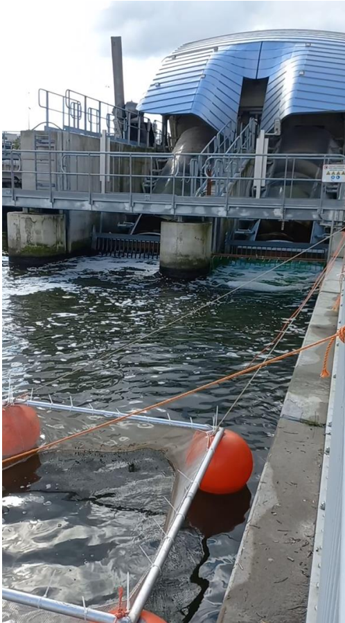
Figuur 2. Aan de stroomafwaartse zijde van de turbine op linkeroever werd via een kader in de sponning een fuik gemonteerd om passerende vissen op te vangen.
