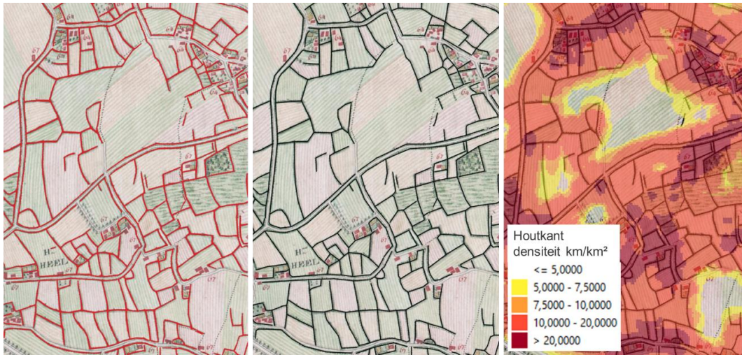
Figuur 4-4 Van gedetecteerde houtkanten (polygonen) naar lijnen en dan naar lijnendensiteit (Ferrariskaart)
