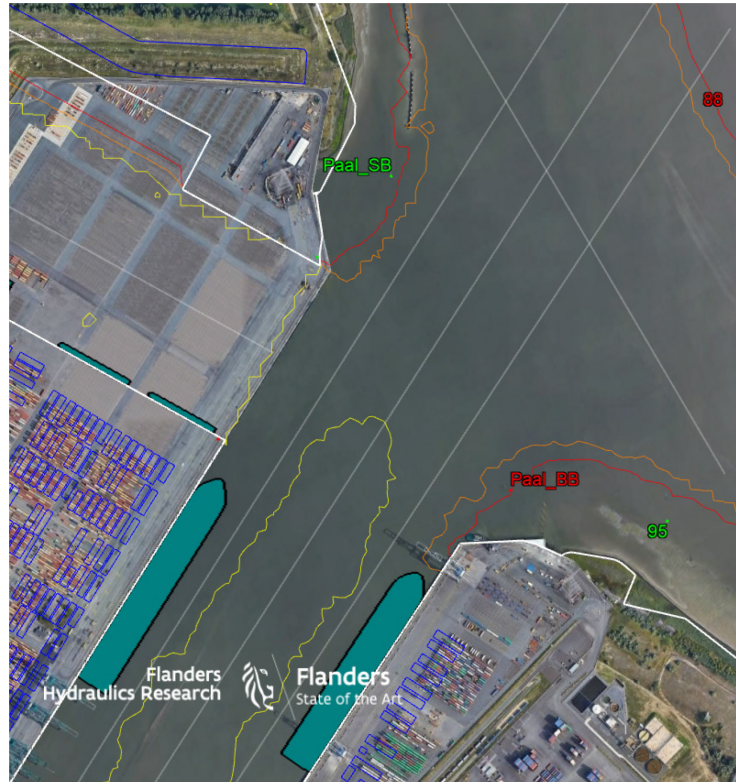
Figuur 40 - Sedimentatie op de hoeken van het Deurganckdok en het tweede getijdedok (oranje -14,5 m LAT, rood -10 m LAT)
