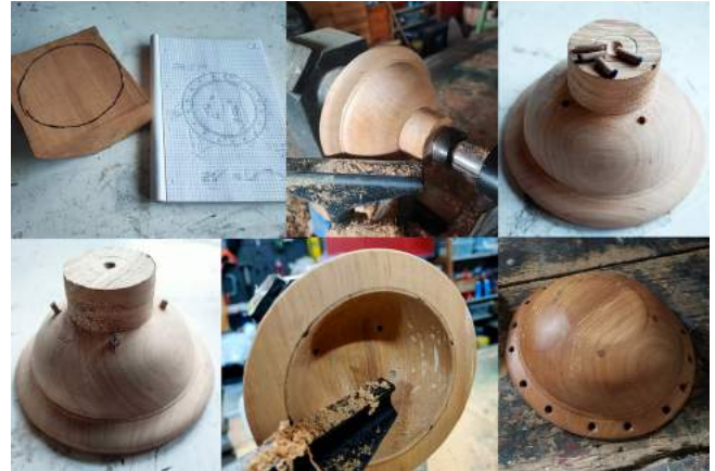
Fig. 3.135 Het maakproces van een replica van de schildknop (foto's: Sebastiaan Pelsmaeker). The production process of a replica of the wooden shield boss (photos: Sebastiaan Pelsmaeker).
