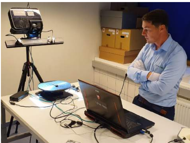
Fig. 2.21 Frederik De Kreyger aan het werk met de 3D-scan van een klein houten object op het draaiplateau (foto: Erfgo3D).
