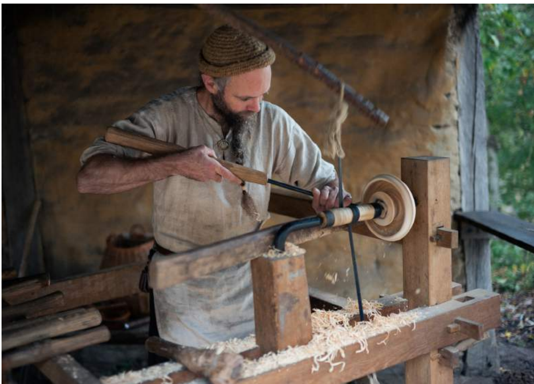
Fig. 3.44 Houtdraaier Martijn van Gerwen draait een kom op de wipdraaibank (foto: prehistorisch dorp Eindhoven/fotograaf: Davey Rietmeijer).
