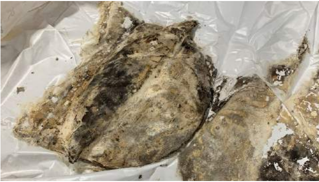
Fig. 5.10 Een dikke schimmellaag bedekt een houten object dat vochtig werd ingepakt in plastic folie (foto: WOODAN).
