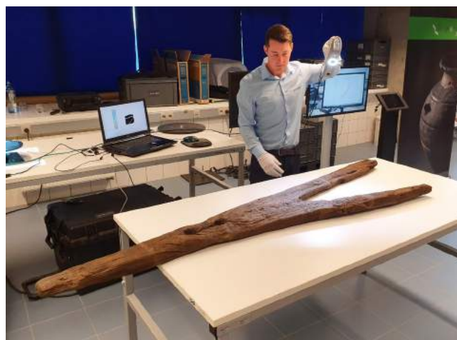
Fig. 2.19 Voor grote objecten, zoals dit essenhouten object uit Zele, is een nauwkeurigheidsgraad van 0,02 mm of zelfs 0,2 mm meestal voldoende (foto: Erfgo3D).
