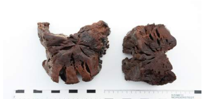
Fig. 5.2 Tijdens opslag door uitdroging vervormd en gekrompen hout (foto: WOODAN). Wood distorted and shrunk due to dehydration during storage (photo: WOODAN).
