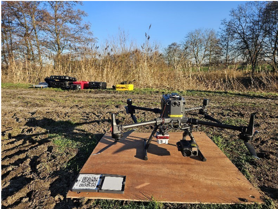
Figuur 42: Drone uitgerust met o.m. een infraroodcamera om lekdetectie doorheen de Durmedijk in beeld te brengen
