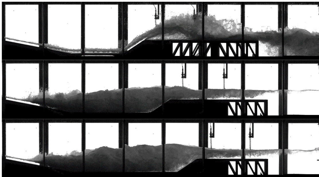
Figuur 12 – Geometrie G7 overloophoogte 0.61 m en laag afwaarts peil stromingspatroon bij grachtbreedte 2.0 m (boven), 3.0 m (midden) en 4.0 m (onder)
