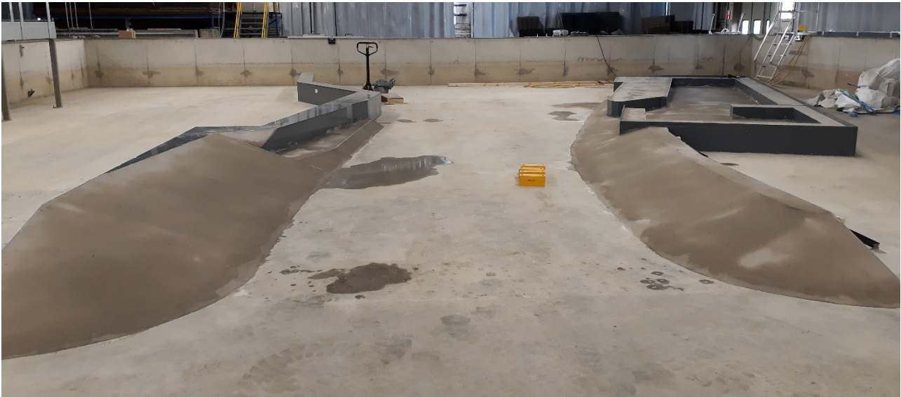
Figuur 30 – Fysisch model van deel van Oostendse haven: verbrede vaargeul en Montgomerydok (schaal 1/50)
