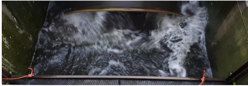
Foto 9: Om te voorkomen dat testvissen ontsnappen werden wegneembare roosters stroomopwaarts van de vijzels geplaatst. Het oranje touw toont de bevestigingspunten waarmee het rooster van de onderzocht buisvijzel uit de geleiders kon gelift worden.
