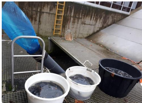
Foto 10: Testvissen worden met een schepnet via een natte buis voorzichtig ingebracht aan de basis van de stormvijzel op linkeroever van het PGGs.
