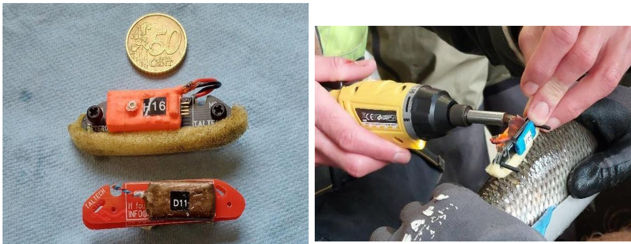
Foto 15: Voorbeeld van een backpack-sensor zoals gebruikt bij blankvoorn en paling (links). Bevestiging van een sensor op de rugvin van een blankvoorn (rechts).
