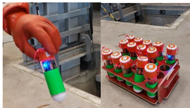
Foto 14: Voorbeeld van een geactiveerde BDS-sensor van de Universiteit van Tallinn (links) en een reeks sensoren klaargemaakt om in te zetten tijdens één van de proeven (rechts).
