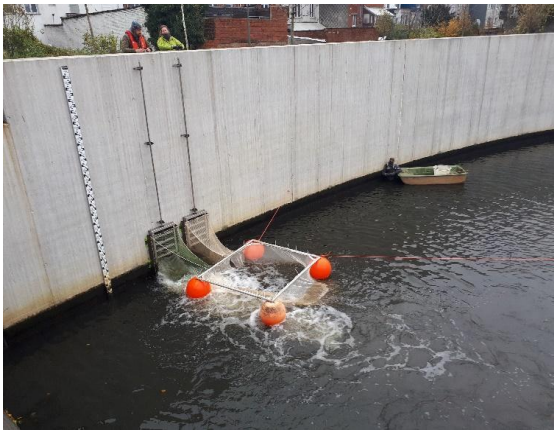
Foto 17: Links: Noors leefnet op de twee uitstroomopeningen van het gravitair omloopkanaal. Rechts: Uit het Albertkanaal stroomopwaarts migrerende paarijpe brasems konden via het gravitair omloopkanaal hun stroomopwaartse paaimigratie verderzetten in de rivier Groot Schijn
