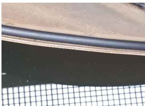
Foto 3: Close-up van een waaiersblad of schroefblad van een stormvijzel met langs de opwaartse zijde een rubberstrip erop gemonteerd, de ‘Elst-toepassing’ (PGGS). Deze foto geeft de niet-optimale montage weer waarbij de strip te ver verscholen zit achter het waaiersblad waardoor de ruimte nauwelijks verkleind wordt tussen het vijzelblad en de opvoergoot (niet te zien op deze foto).
