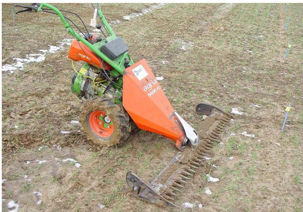
Foto 6: Agria maaitoestel (maaibreedte 1,45m ; gewicht ca. 80kg) (Foto: Bert Van Gils)
