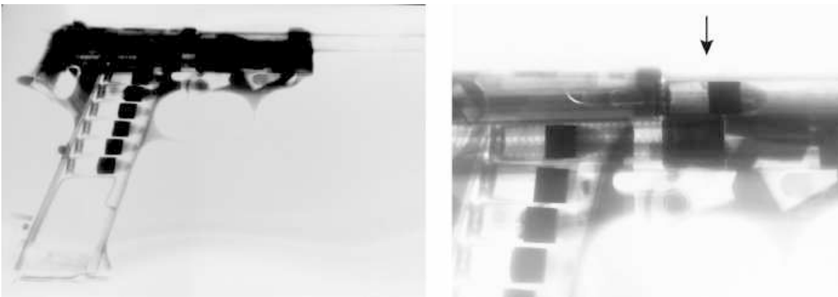
Figuur 60: röntgenopname van het P38 pistool. In de detailopname (rechts) is duidelijk te zien dat er een kogel in de kamer van het pistool zit (© agentschap Onroerend Erfgoed).
