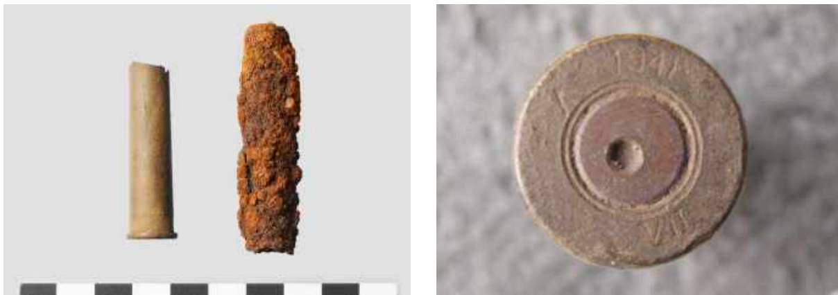
Figuur 96: Afgevuurde huls van een koperen Britse kogelhuls (.303) vergeleken met een sterk gecorrodeerde afgevuurde Duitse huls van het MG15 machinegeweer. Rechts de markering op de achterzijde van de Britse huls (© agentschap Onroerend Erfgoed).
