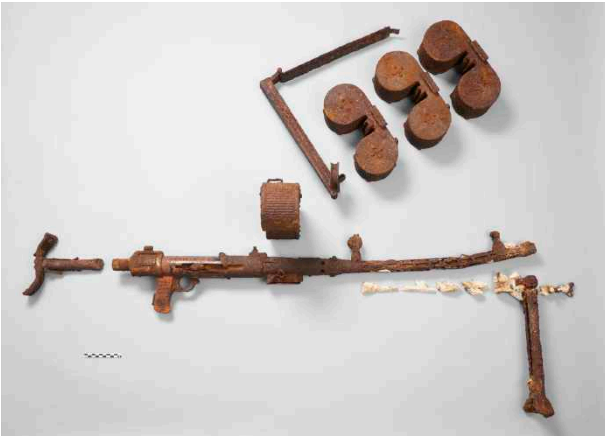
Figuur 35: MG15 met tweepikkel, vier trommelladers en draagframe. Van het onderdeel in aluminium waarmee de tweepikkel op de loop werd gemonteerd is slechts een witte brokkelige substantie bewaard gebleven (© agentschap Onroerend Erfgoed).
