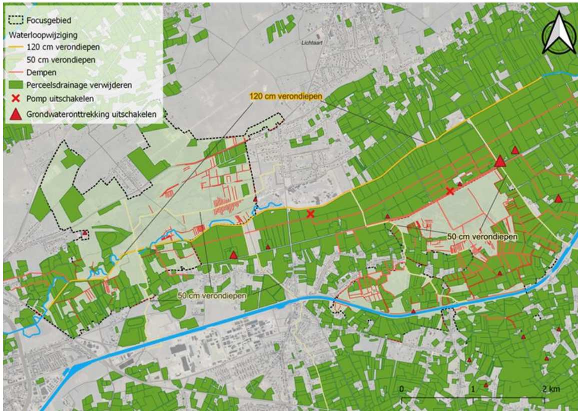
Afbeelding 4.1 Een technisch scenario omvat een reeks aan maatregelen om drainage van het (oppervlakkige) grondwater in en rond de natuurgebieden tijdens droge periodes te verminderen en dus de GLG te verhogen
