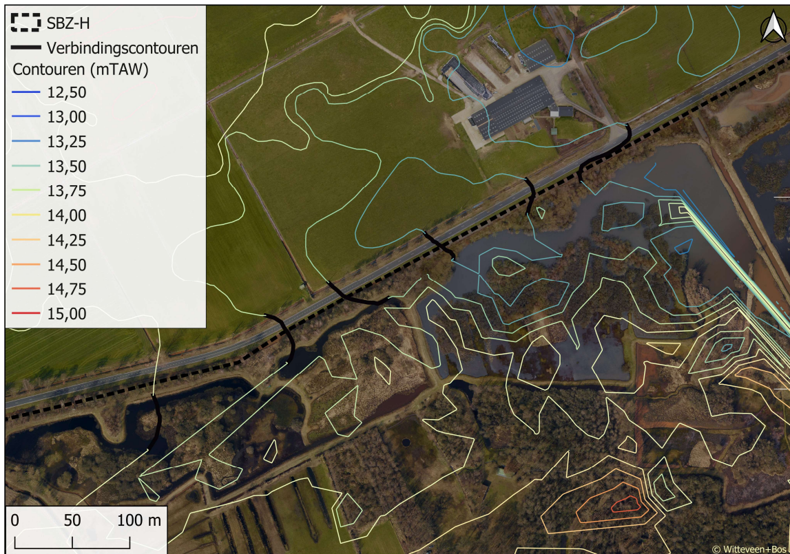
Afbeelding 2.4 Het historisch maaiveld van de landbouwpolder en het natuurreservaat sluit ter hoogte van de overgangszone (Roerdompdijk) goed op elkaar aan
