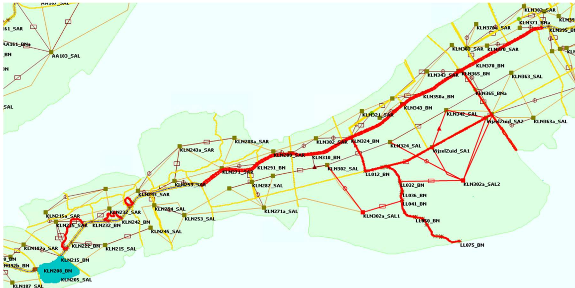
Afbeelding 4.4 Screenshot van het focusgebied in het ICM-model na toevoeging van zijlopen, verbreding en meanders. De modelaanpassingen zijn weergegeven in het rood. (Kaart: W+B 2023)
