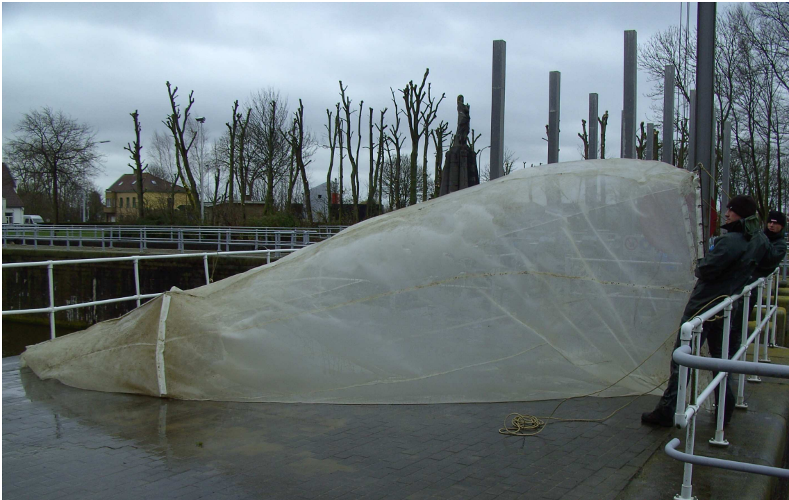
Fig. 4. De fuij waarmee stroomopwaarts migrerende glasaal bemonsterd werd.
