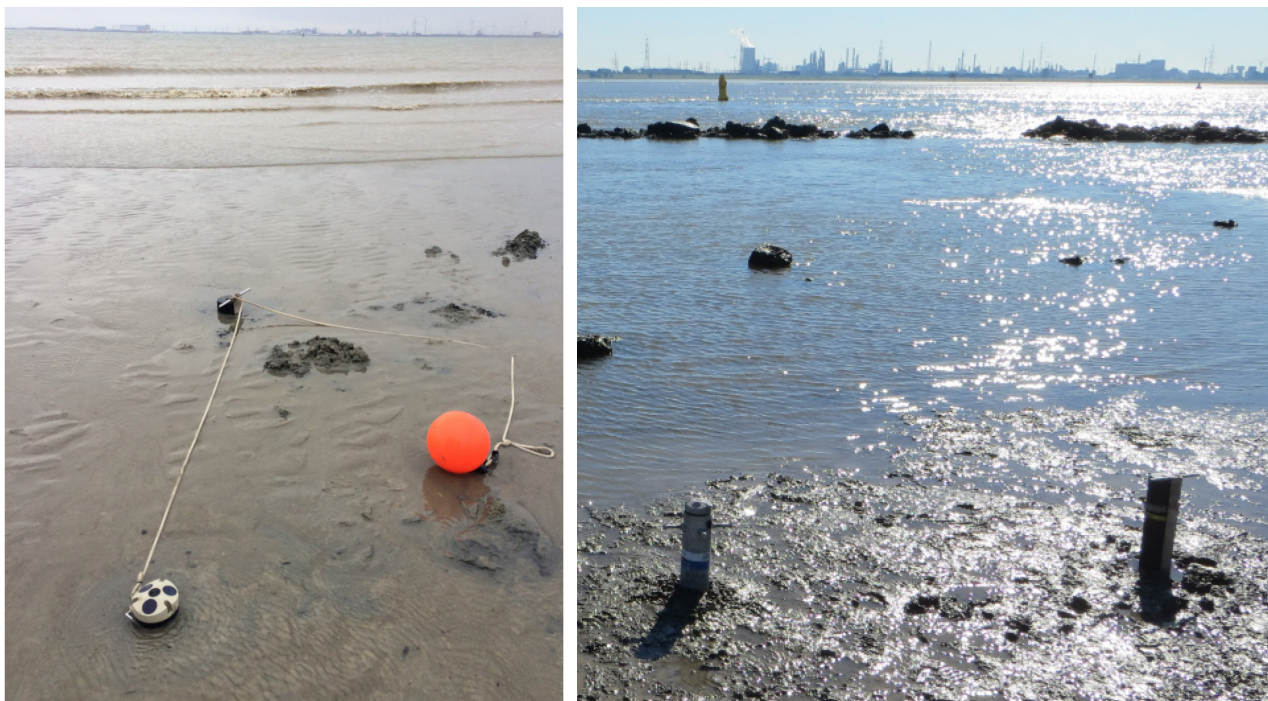
Figuur 6: Foto van de Aquadopp en druksensor uitgezet in het veld, bij de Hooge Platen (links) en Saeftinghe (rechts)
