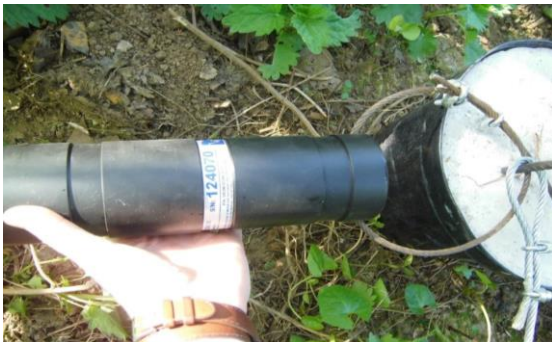
Figuur 15. De akoestische receiver (zwart) wordt bevestigd aan een gewicht en wordt met behulp van een stalen kabel aan een obstakel langsheen het water bevestigd (Foto links). De receiver wordt door de kabel en/of een boei verticaal gehouden tijdens de metingen (Foto rechts).
