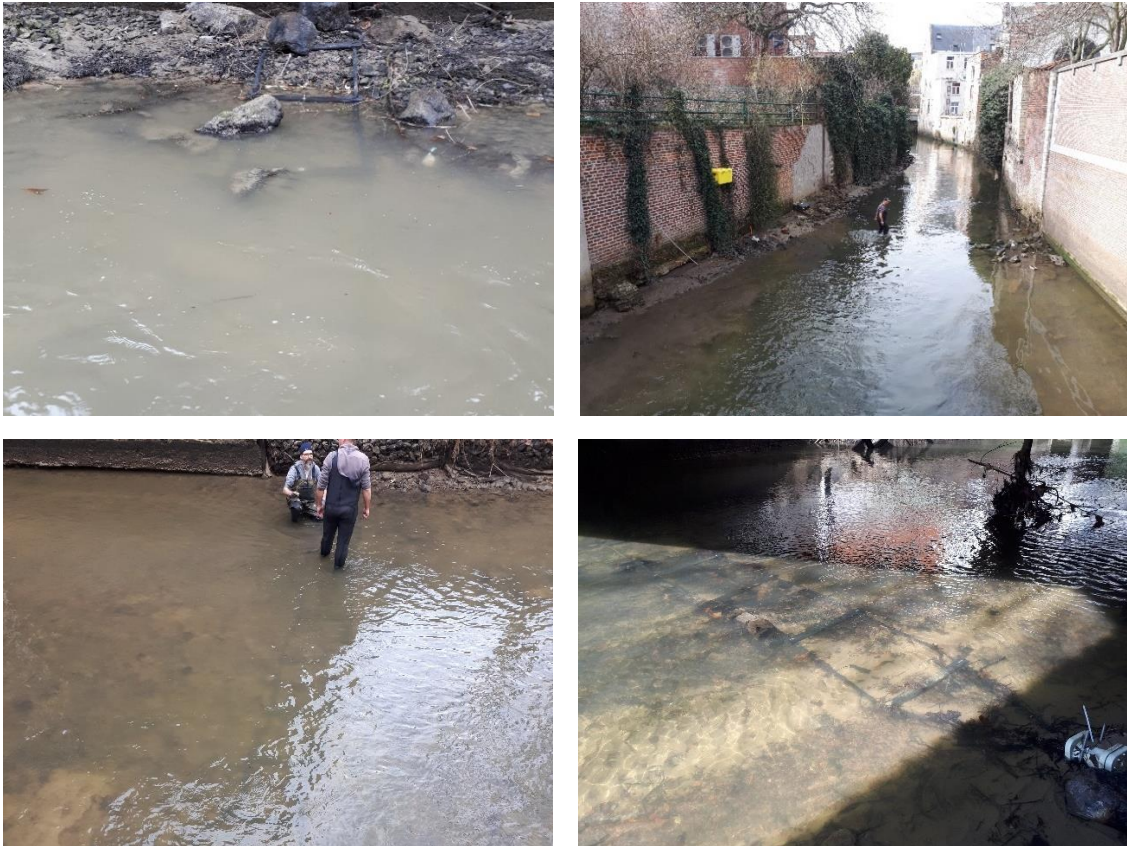
Figuur 18. Plaatsing van flat-bed PIT-antennes op vier strategische locaties ten opzichte van de kunstwerken op de bodem van de hoofdarm van de Dijle in Leuven. Van links naar rechts en van boven naar onder: antenne stroomafwaarts van de Stuw K.v.Lotharingen, antenne stroomopwaarts van de Stuw K.v.Lotharingen, antenne stroomafwaarts van de Dijlemolens, antenne stroomopwaarts van de Dijlemolens.
