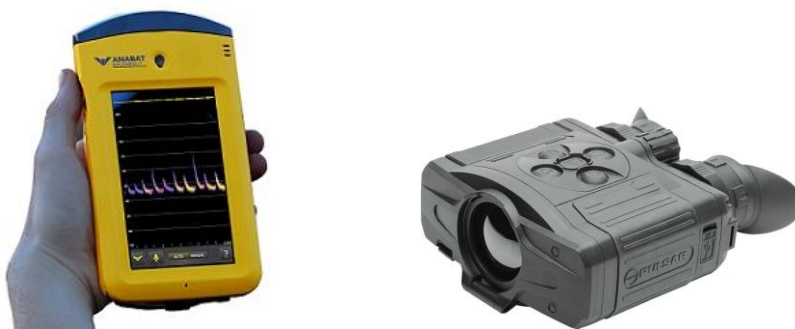
Foto 23. Anabat Walkabout batdetector (links), en de Pulsar Accolade 2 LRF XP50 PRO warmtebeeldkijker (rechts).
