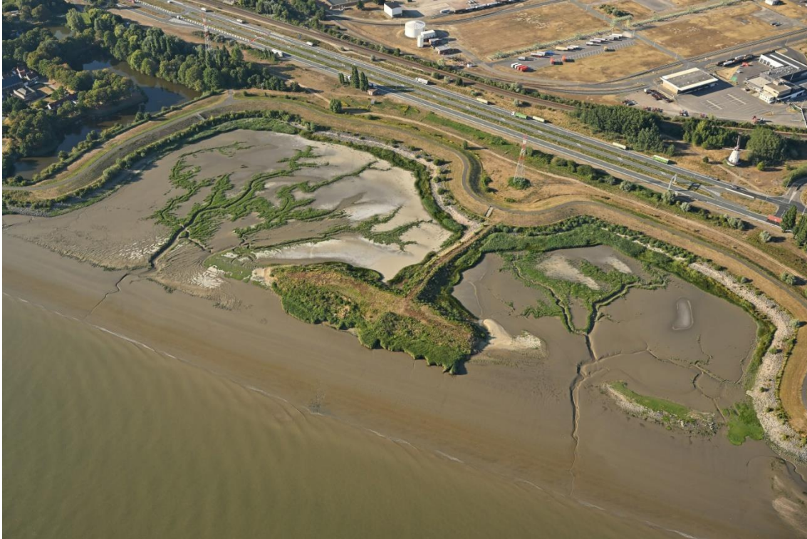
Figuur 4. Luchtfoto ontpoldering Lillo. Geschikte hoogteligging, voldoende brede bressen met kreekaanzet resulteren in een natuurlijk dendritisch kreenstelsel en vegetatieontwikkeling.
