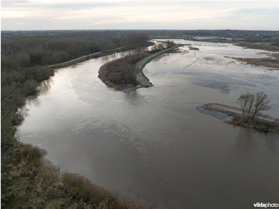
Figuur 5. Hoogwater bij springtij in het Klein Broek – ontpoldering oktober 2023. Beeld winter 2024. Dronebeeld van oostelijke bres. Brede bressen garanderen goede wateruitwisseling en voldoende dynamiek in de ontpoldering.
