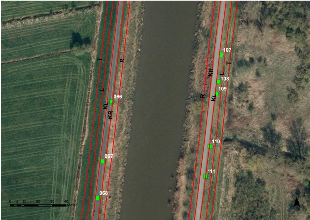
Figuur 61 Voorbeeld van de basiskaart met 5 parallelle lijnen, één voor elke dijkzone (R, KR, KL, L, T), illustratief getekend op de dijk. De groene vierkantjes geven als voorbeeld enkele waypoints op grond waarvan homogene vegetatie-eenheden worden onderscheiden.
