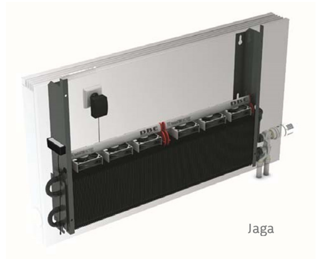
FIGUUR 99. Convector uitgerust met miniventilatoren (afbeelding Jaga) De nieuwste ontwikkelingen op het gebied van convectoren zijn gericht op het verhogen van de warmteafgifte bij lagere watertemperaturen (aanpassing van de vorm en de afmetingen van de convectieribben rond de buizen).
