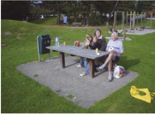
Fig. 2.5.1e Picknicktafels met maar aan één zijde een bank zijn maar voor de helft bruikbaar, wanneer er niemand in een rolstoel bij is.
