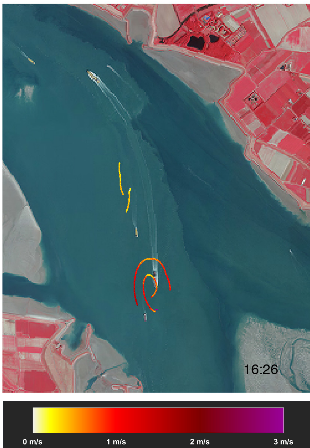
Figuur 16 – Overzicht stroompatronen voor loslaatmoment 7 tijdens eerste meetdag Tijdstip [MEZT] onderaan rechts is het moment van te water lating van de vlotters
