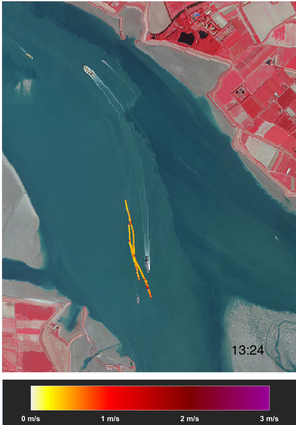
Figuur 10 – Overzicht stroompatronen voor loslaatmoment 1 tijdens eerste meetdag Tijdstip [MEZT] onderaan rechts is het moment van te water lating van de vlotters
