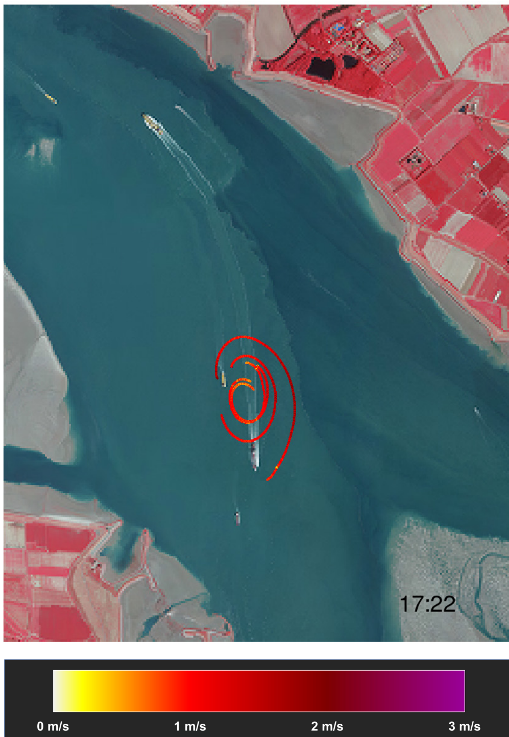
Figuur 33 – Overzicht stroompatronen voor loslaatmoment 8 tijdens derde meetdag Tijdstip [MEZT] onderaan rechts is het moment van te water lating van de vlotters
