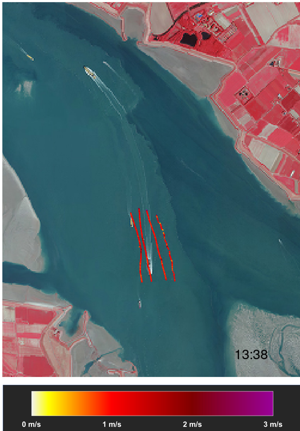
Figuur 18 – Overzicht stroompatronen voor loslaatmoment 2 tijdens tweede meetdag Tijdstip [MEZT] onderaan rechts is het moment van te water lating van de vlotters
