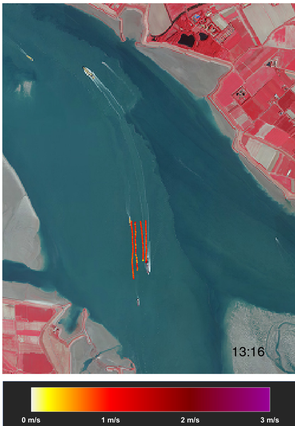
Figuur 17 – Overzicht stroompatronen voor loslaatmoment 1 tijdens tweede meetdag Tijdstip [MEZT] onderaan rechts is het moment van te water lating van de vlotters
