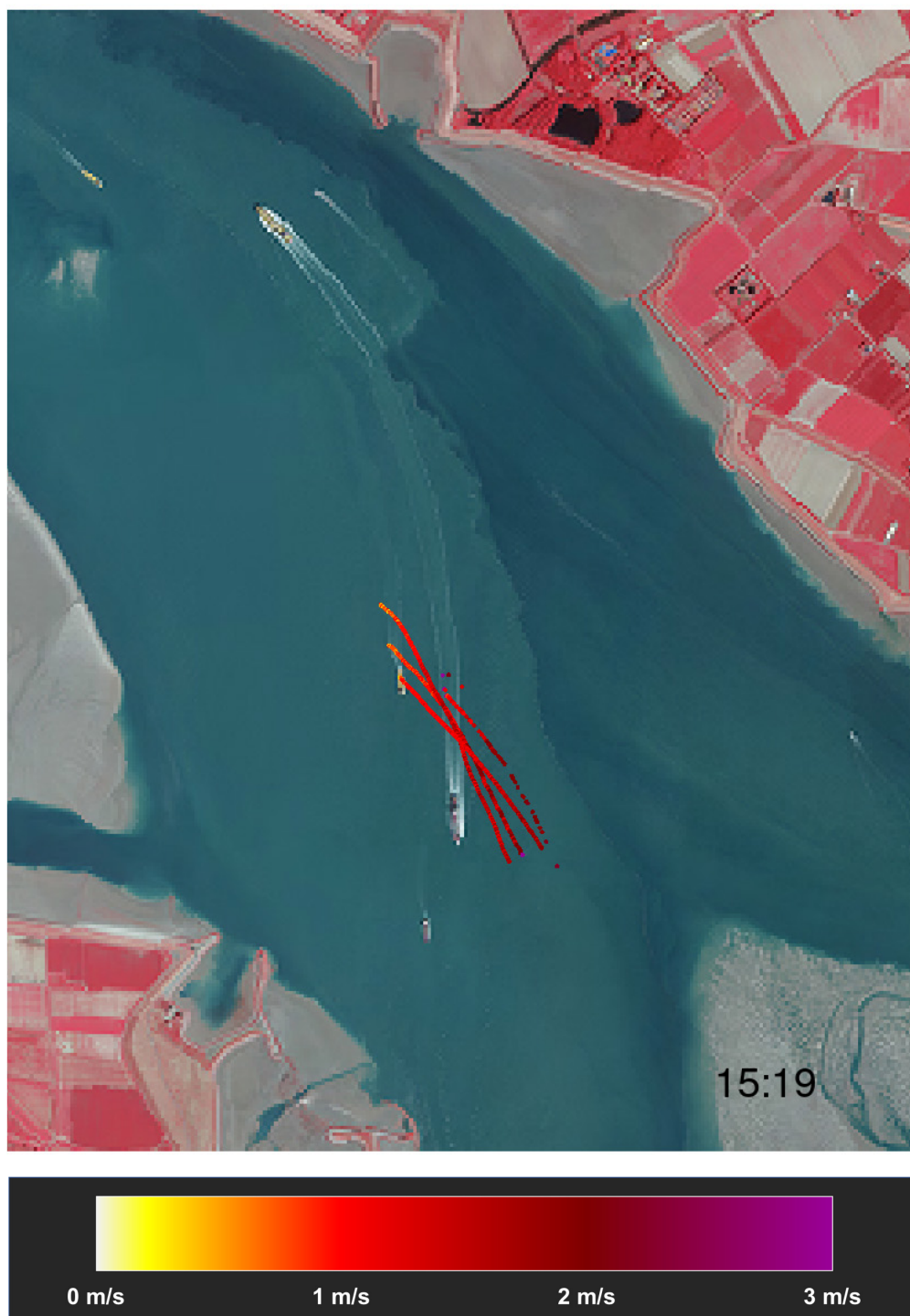
Figuur 22 – Overzicht stroompatronen voor loslaatmoment 6 tijdens tweede meetdag Tijdstip [MEZT] onderaan rechts is het moment van te water lating van de vlotters
