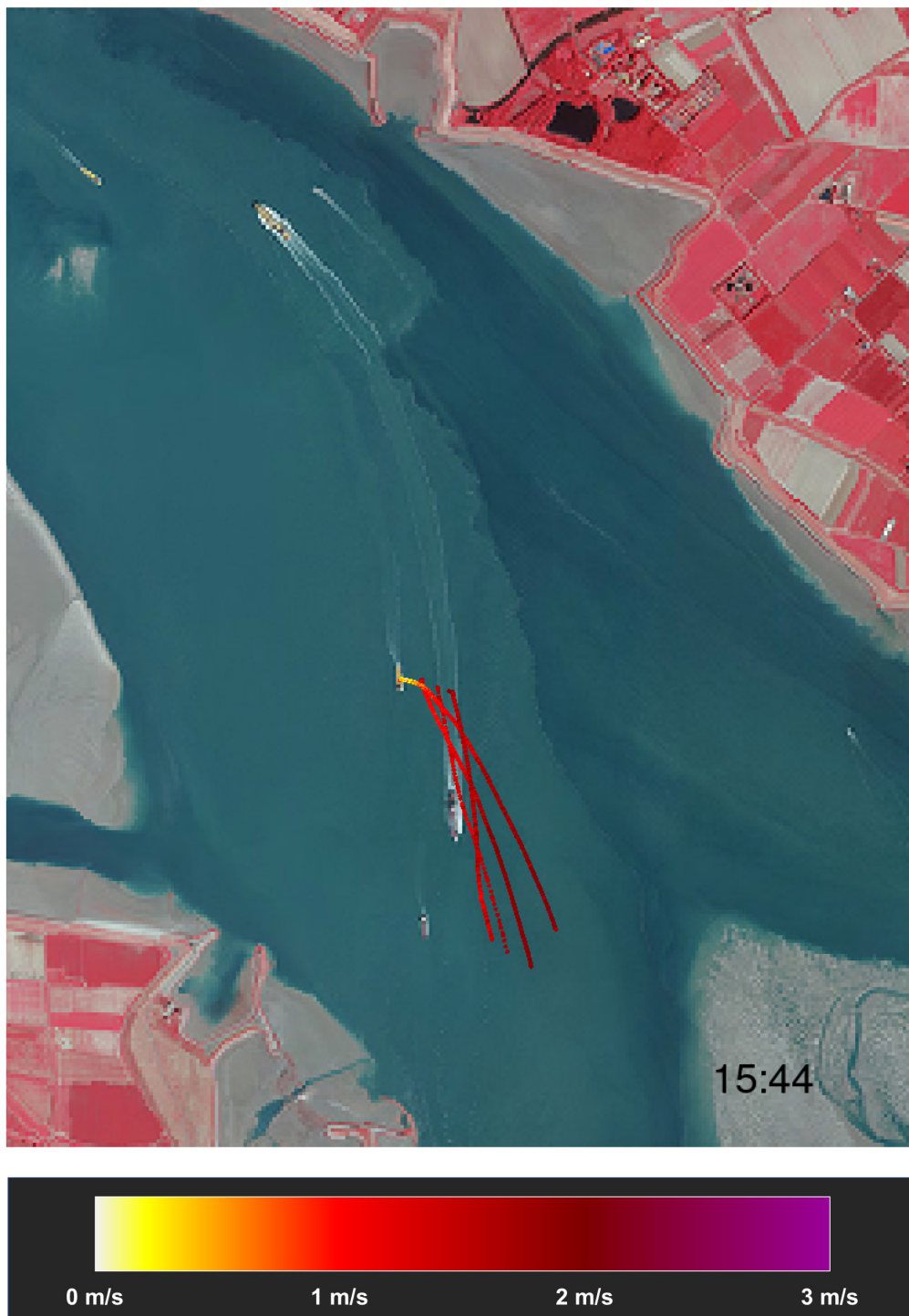
Figuur 29 – Overzicht stroompatronen voor loslaatmoment 4 tijdens derde meetdag Tijdstip [MEZT] onderaan rechts is het moment van te water lating van de vlotters
