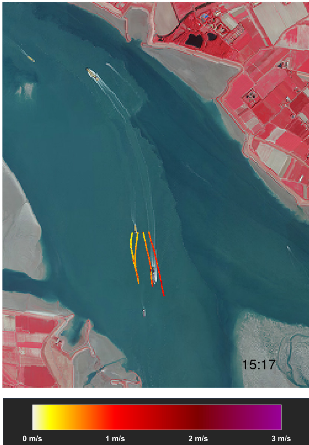
Figuur 28 – Overzicht stroompatronen voor loslaatmoment 3 tijdens derde meetdag Tijdstip [MEZT] onderaan rechts is het moment van te water lating van de vlotters
