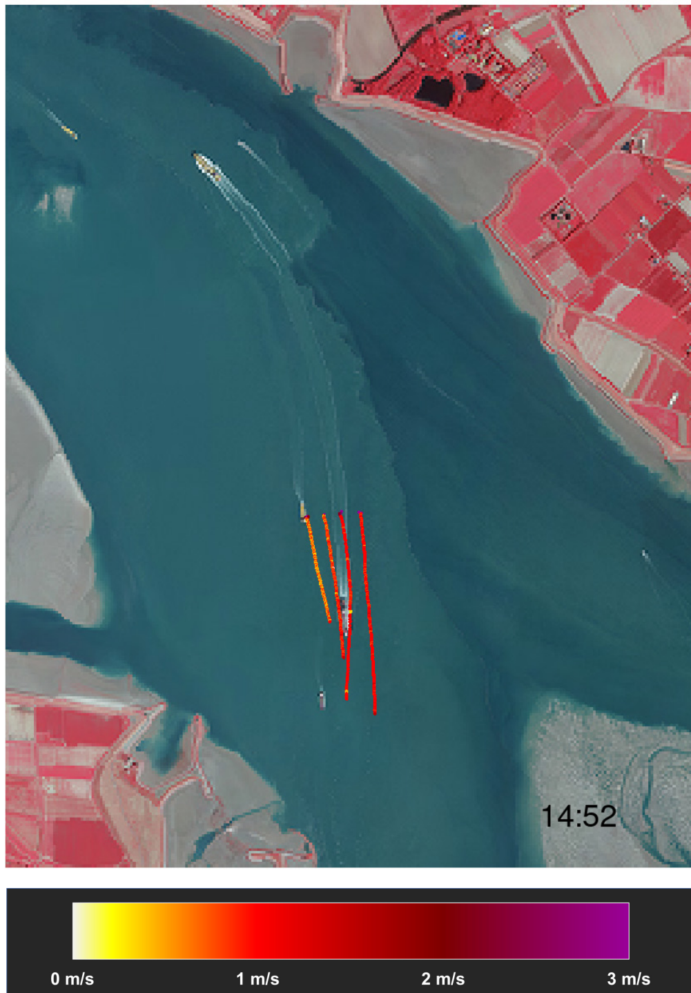
Figuur 27 – Overzicht stroompatronen voor loslaatmoment 2 tijdens derde meetdag Tijdstip [MEZT] onderaan rechts is het moment van te water lating van de vlotters
