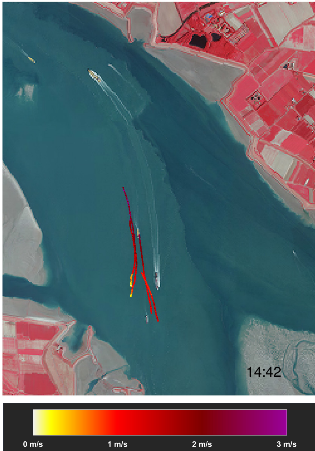
Figuur 12 – Overzicht stroompatronen voor loslaatmoment 3 tijdens eerste meetdag Tijdstip [MEZT] onderaan rechts is het moment van te water lating van de vlotters
