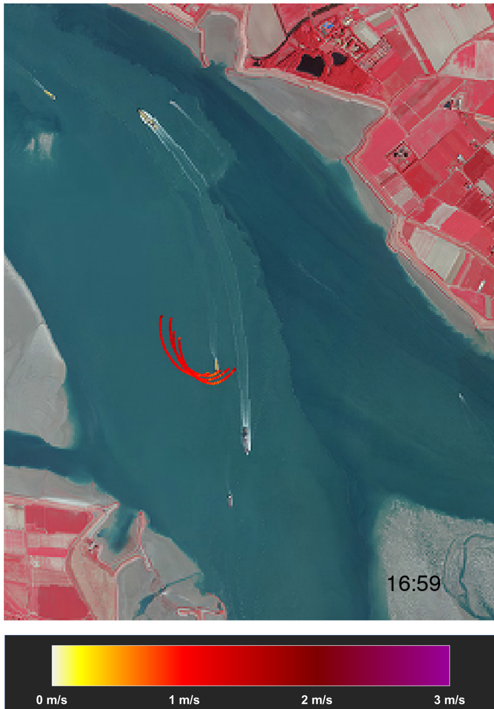
Figuur 32 – Overzicht stroompatronen voor loslaatmoment 7 tijdens derde meetdag Tijdstip [MEZT] onderaan rechts is het moment van te water lating van de vlotters
