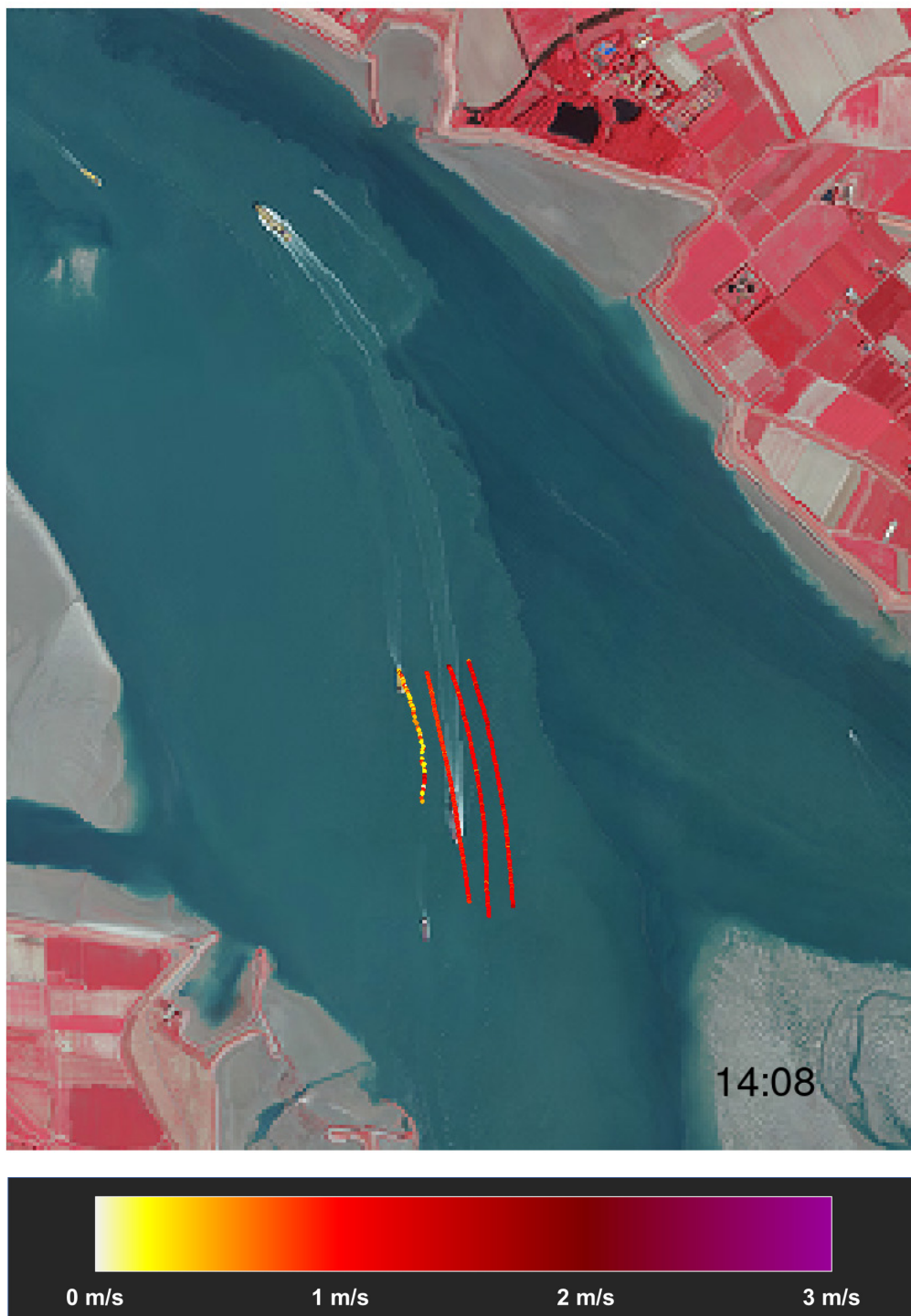
Figuur 19 – Overzicht stroompatronen voor loslaatmoment 3 tijdens tweede meetdag Tijdstip [MEZT] onderaan rechts is het moment van te water lating van de vlotter
