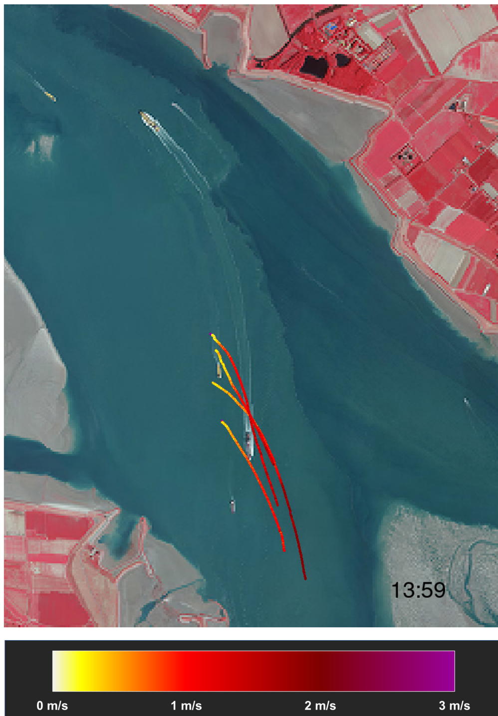
Figuur 11 – Overzicht stroompatronen voor loslaatmoment 2 tijdens eerste meetdag Tijdstip [MEZT] onderaan rechts is het moment van te water lating van de vlotter
