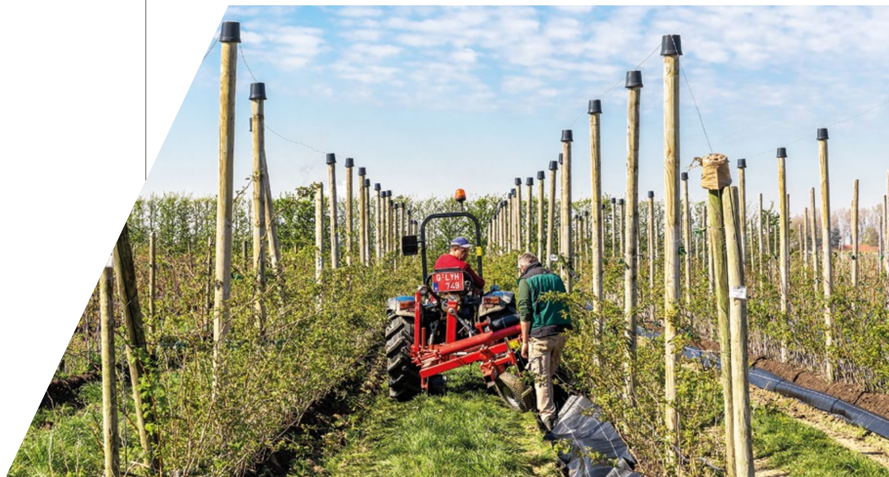
Ontwikkeling prototype machine voor het automatisch plaatsen van gronddoeken in kleinfruitplantages. Bekijk het filmpje op Ontwikkeling prototype machine in kleinfruitsector
