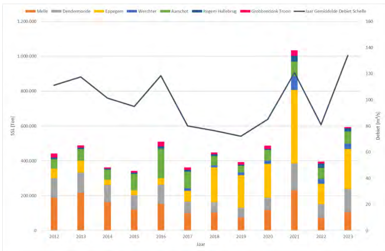
Figuur 75 – Historisch overzicht van de sedimentvrachten per stroomgebied (EWI-gecorrigeerd). Voor de locatie Werchter is pas data beschikbaar vanaf 2017.
