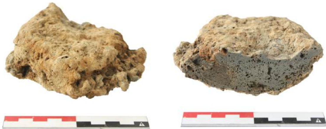
Fig. 6.70: Plano-convexe smeedhaardbodem NIJ WP2 V.x8: zijaanzicht (links) en doorsnede (rechts).
