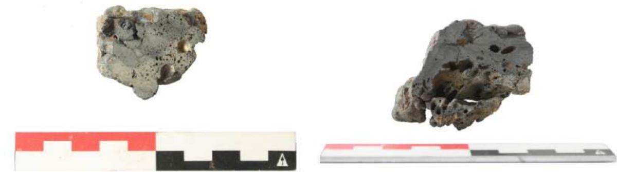
Fig. 6.67: Doorsnedes van fragmenten vloeislak uit WP2 (Stalen NIJ WP2 Zx6 St1 (links) & NIJ WP2 Z17 St1 (rechts)).
