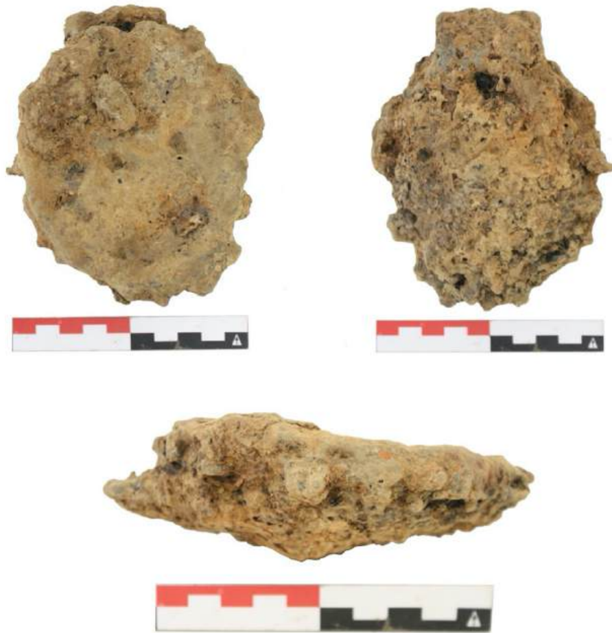
Fig. 6.69: Plano-convexe smeedhaardbodem NIJ WP2 V.16-1: bovenaanzicht (links boven), onderaanzicht (rechts boven) en zijaanzicht (onderaan).
