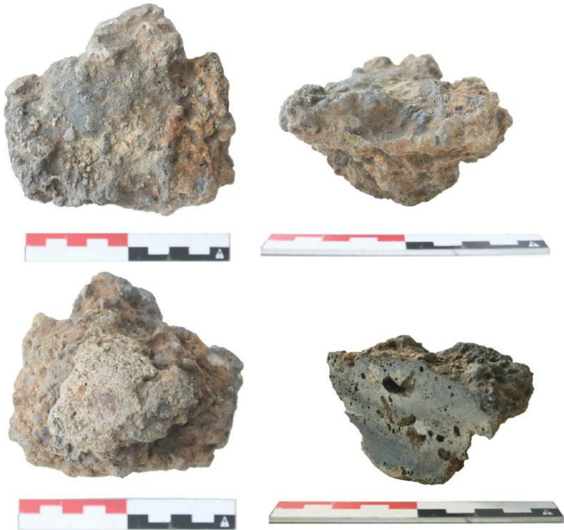
Fig. 6.53: Smeedhaardbodem V OE 4 D 60: bovenaanzicht (links boven), onderaanzicht (links onder), zijaanzicht (rechts boven) en doorsnede (rechts onder).
