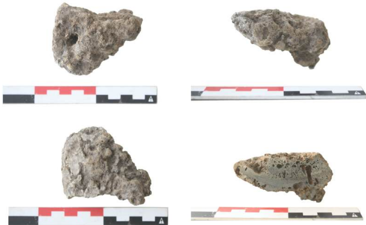
Fig. 6.57: "Globulaire" ijzerslak V OE 4 E 70-75: bovenaanzicht (links boven), onderaanzicht (links onder), zijaanzicht (rechts boven) en doorsnede (rechts onder).
