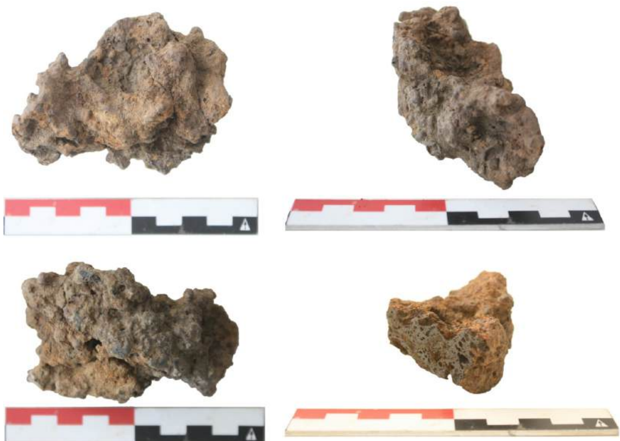
Fig. 6.48: “Knobbelige” ijzerslak V174-1: bovenaanzicht (links boven), onderaanzicht (links onder), zijaanzicht (rechts boven) en doorsnede (rechts onder).
