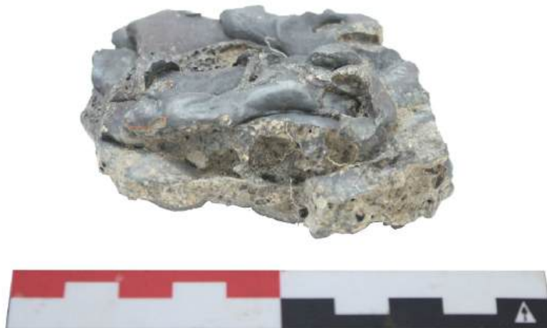
Fig. 6.90: Een vloeislak uit S1466.
