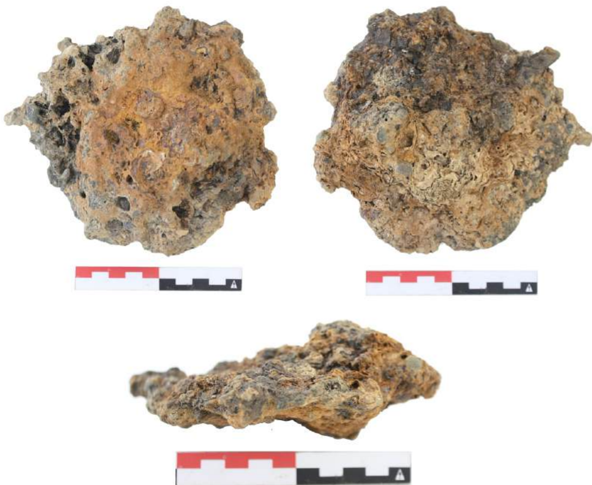
Fig. 6.82: Ijzerslak V.19: bovenaanzicht (links boven), onderaanzicht (rechts boven), zijaanzicht (onderaan).
