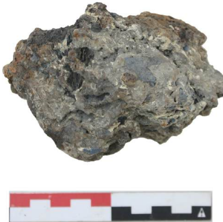
Fig. 6.105: Smeedslak met blauwe verkleuring uit S488.
