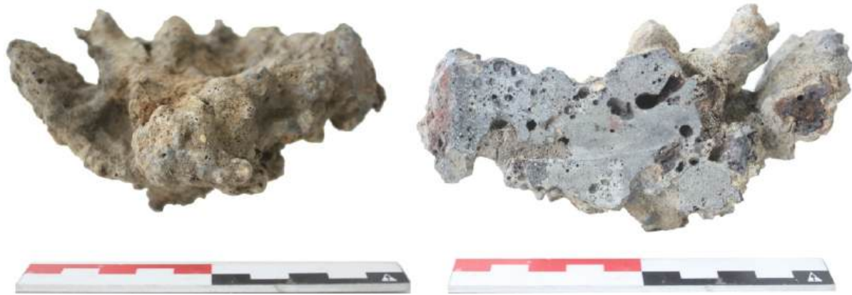
Fig. 6.39: Plano-convexe ijzerslak V124-2a: zijaanzicht (links) en doorsnede (rechts).
