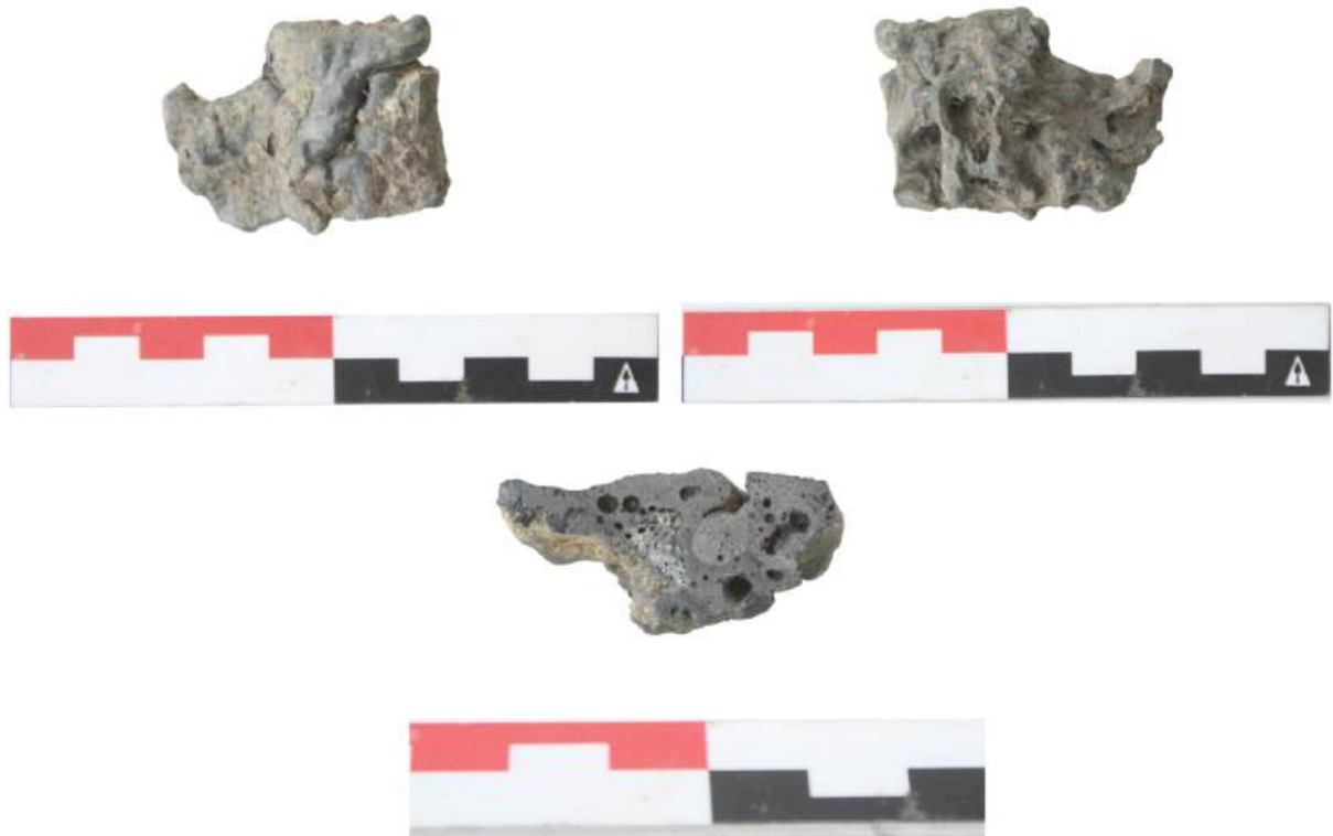
Fig. 6.47: “Knobbelige” ijzerslak V129-1b: bovenaanzicht (links boven), onderaanzicht (rechts boven) en doorsnede (onderaan).
