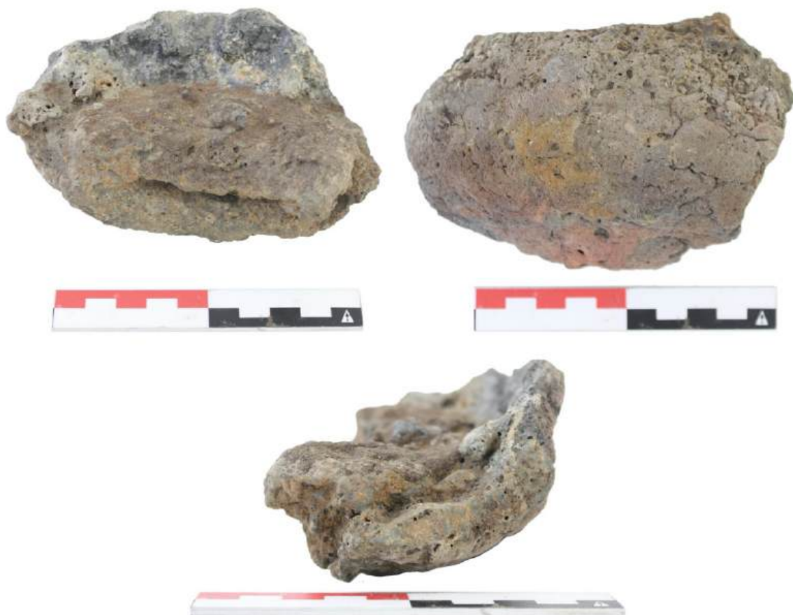
Fig. 6.73: Smeedhaardbodem met resten aardewerk V.x7: bovenaanzicht (links boven), onderaanzicht (rechts boven) en zijaanzicht (onderaan).
