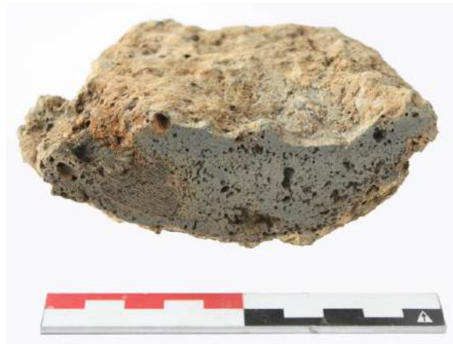
Fig. 4.8: Voorbeeld van een doorsneden smeedhaardbodem afkomstig van Nijlen-Mussenpad.
