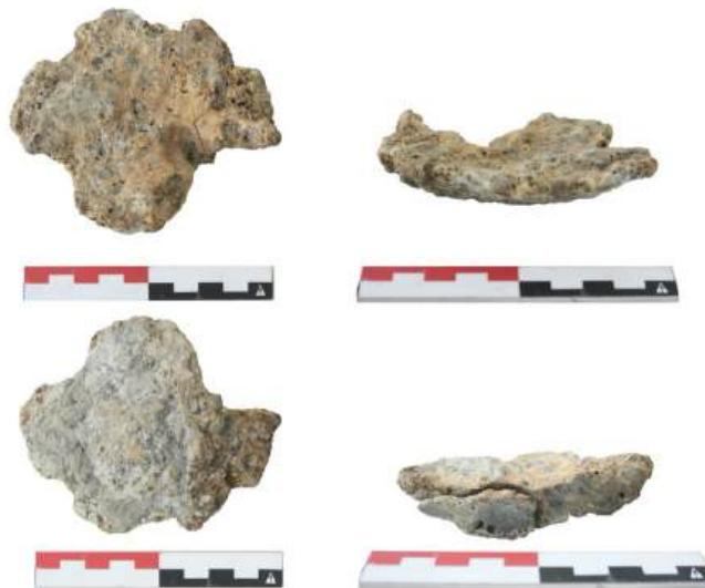
Fig. 6.21: Brandstofslak V250-1: bovenzijde (links boven), onderzijde (links onder), zijaanzicht (rechts boven) en doorsnede (rechts onder).
