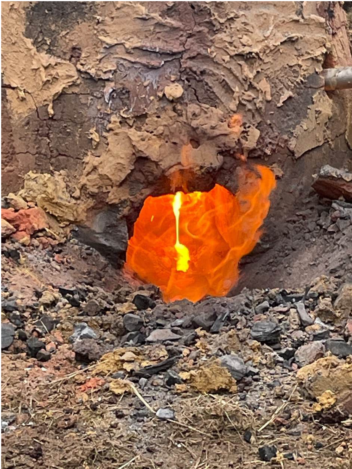
Fig. 7.5: Zicht op de opening van de oven waar een ijzerslak aan het vormen is.
