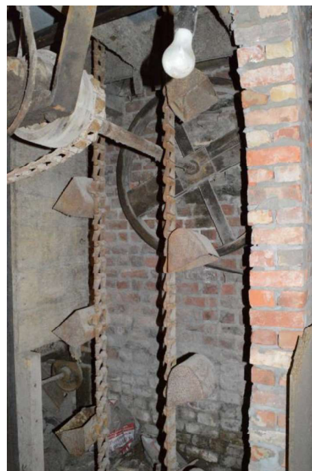
Fig. 36 – Jacobs ladder om de gewassen wortels over te hevelen naar de snijmachine in de cichoreiast op de Heerlijkheid van Heule in Heule (© 2017 Frank Becuwe).
