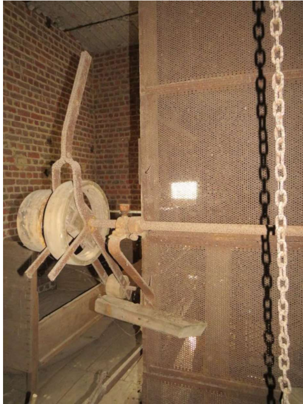
Fig. 83 (links) – Zakkenliër (met zwengel, ketting en windas) in de koel- en werkruimte tussen de ast en het magazijn van de cichoreiast Delezie in Anzegem (© 2024 Onroerend Erfgoed / Frank Becuwe).
