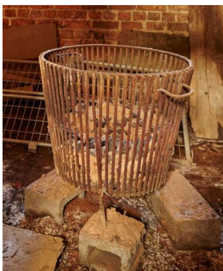
Fig. 57 (links) – Voorbeeld van een vuurkorf voor het branden van cokes in een ast (© 2016 Onroerend Erfgoed / Kris Vandevorst).
