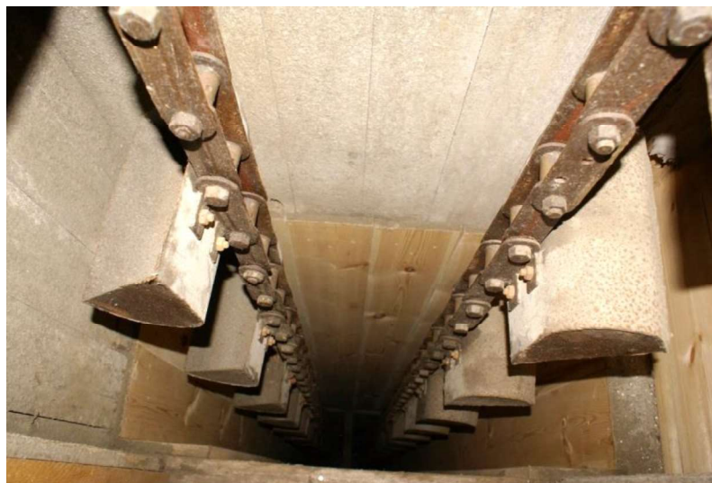
Fig. 52 (links) – In één houten koker ingekaste elevator om de gesneden cichoreiwortels naar de bovenste eestvloer over te hevelen (Sécherie Deleplace, Vieille-Eglise (Fr.)) (© 2016 Frank Becuwe).
