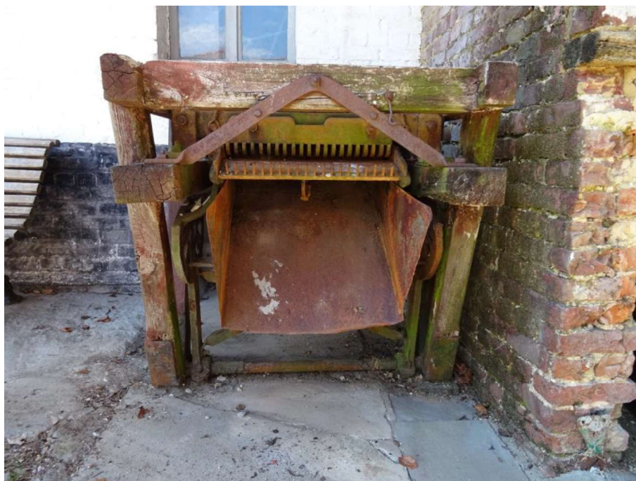
Fig. 43 – De snijmachine in de cichoreidrogerij Van Oudenhove in Steenhuize bij Herzele (Collectie Heemkundige Kring De Hellebaard).
