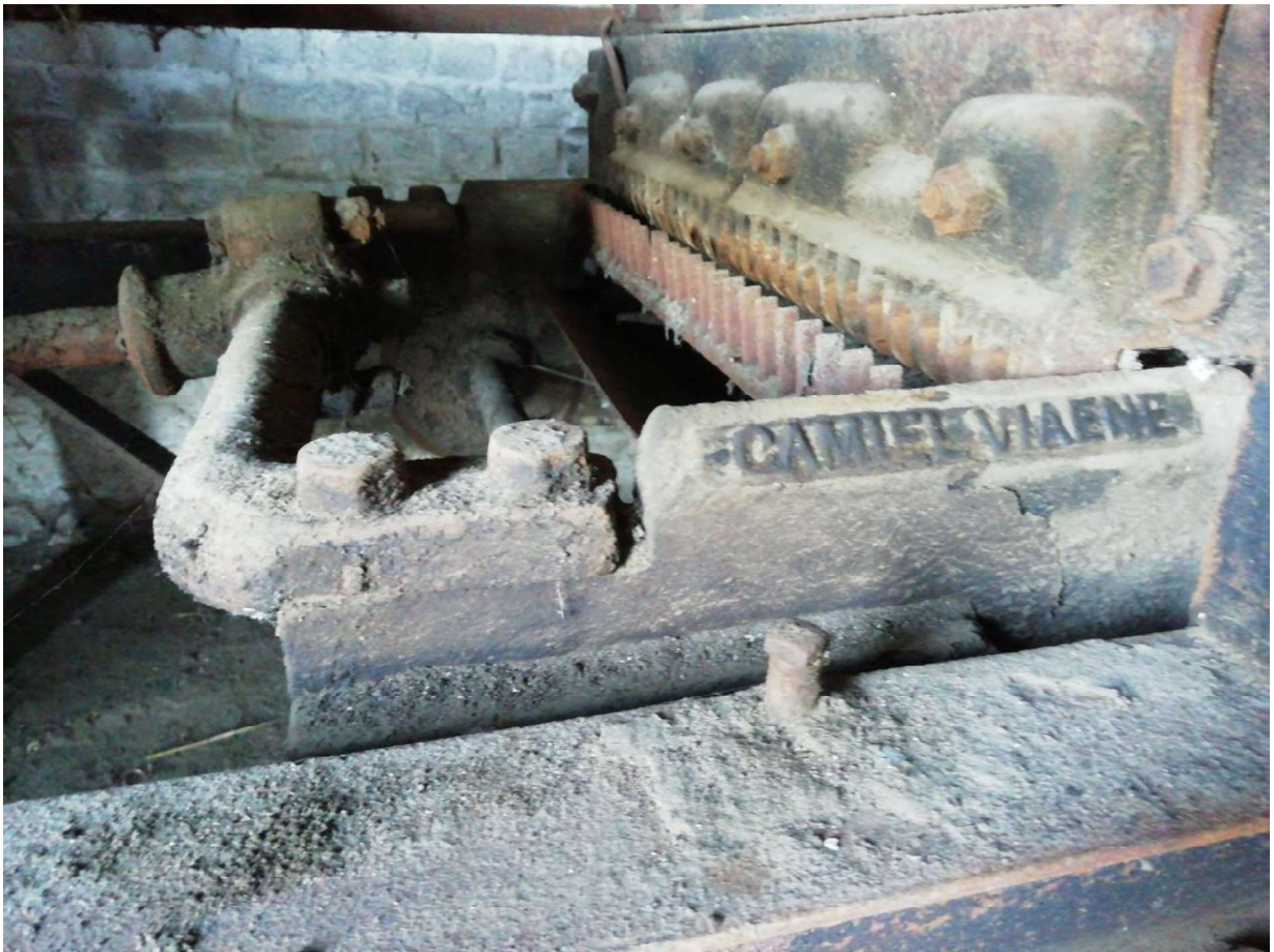
Fig. 252– Detail van de snijmachine van constructeur Camiel Viaene in de cichoreiast Lammertyn in Meulebeke (© 2020 Marc Cappelle).
