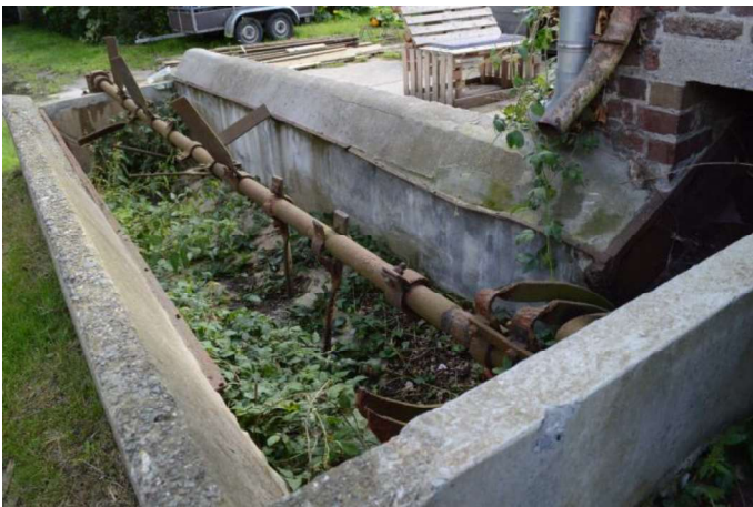
Fig. 34 (boven) – Wasbak met archimedesvijs bij de cichoreiast op de Heerlijkheid van Heule in Heule (© 2017 Frank Becuwe).
