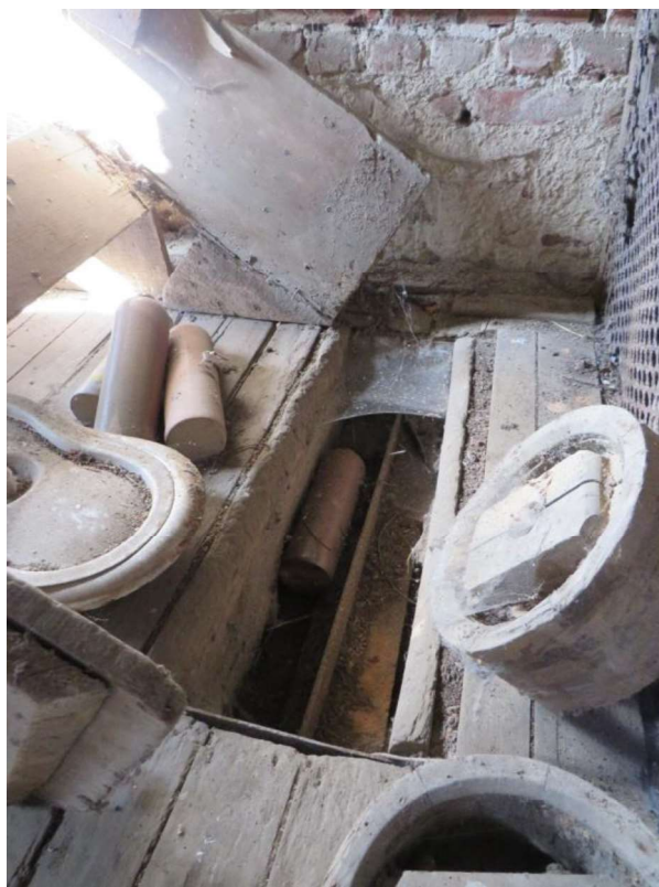
Fig. 44 (links) – De houten toevoegoot naar de snijmachine in de cichoreidrogerij Delezie in Anzegem (© 2024 Onroerend Erfgoed / Frank Becuwe).
