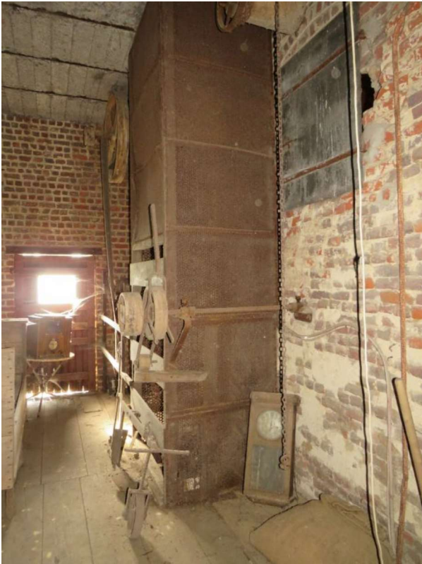
Fig. 83 (links) – Zakkenliër (met zwengel, ketting en windas) in de koel- en werkruimte tussen de ast en het magazijn van de cichoreiast Delezie in Anzegem (© 2024 Onroerend Erfgoed / Frank Becuwe).
