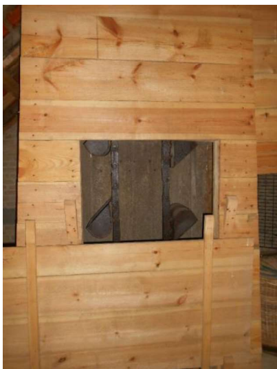
Fig. 52 (links) – In één houten koker ingekaste elevator om de gesneden cichoreiwortels naar de bovenste eestvloer over te hevelen (Sécherie Deleplace, Vieille-Eglise (Fr.)) (© 2016 Frank Becuwe).
