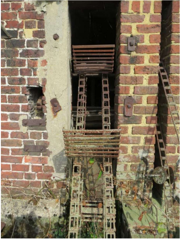
Fig. 256 (links) – Elevator tussen de wasbak en de snijmachine in de cichoreiast Delezie in Anzegem (© 2024 Onroerend Erfgoed / Frank Becuwe).
