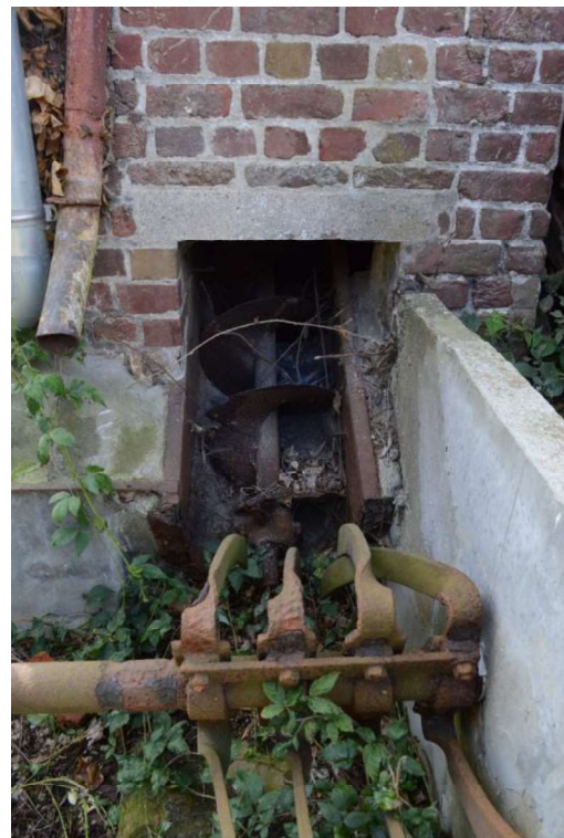
Fig. 34 (boven) – Wasbak met archimedesvijs bij de cichoreiast op de Heerlijkheid van Heule in Heule (© 2017 Frank Becuwe).
