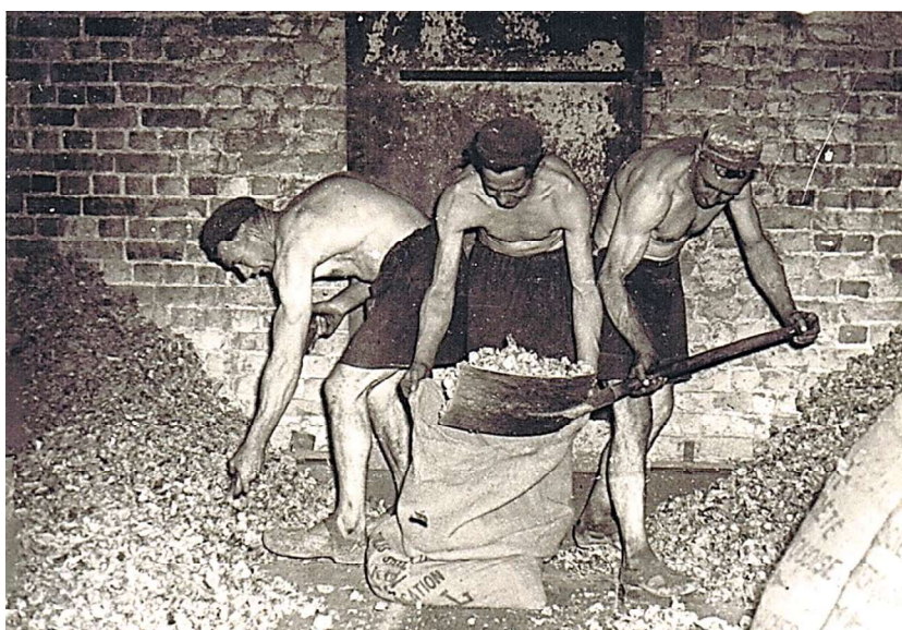
Fig. 65 – Het afscheppen van de gedroogde cichoreibonen in een ast met één eestvloer (Collectie Marc Cappelle).
