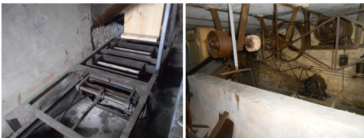
Fig. 46 (links) – Elektrische aangedreven snijmachine in de Sécherie Deleplace in Vieille-Eglise (Fr.) (© 2016 Frank Becuwe). Fig. 47 (rechts) – Elektromotor met drijfwerk in de Sécherie Deleplace in Vieille-Eglise (Fr.) (© 2016 Frank Becuwe).
