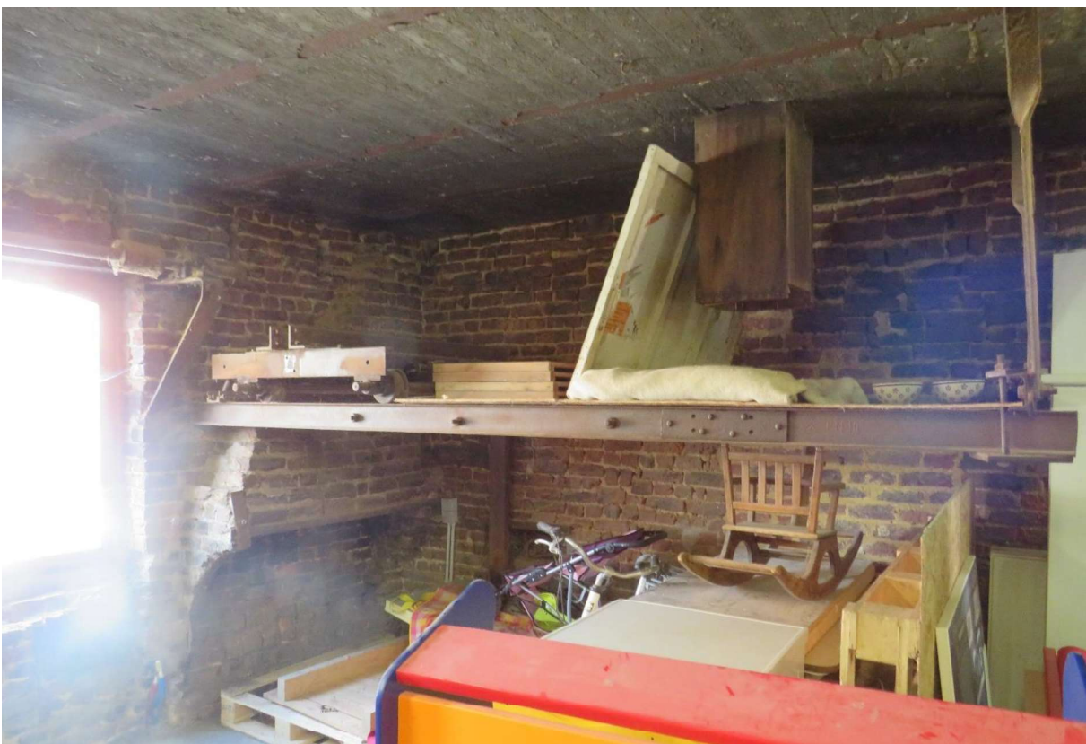
Fig. 239 – Verrijdbaar bovenstel waaraan de brandtrommel ophing (links) en houten bevoorradingsgoot (rechts) in de cichoreibranderij van de cichoreifabriek Eeman (© 2024 Onroerend erfgoed / Frank Becuwe).
