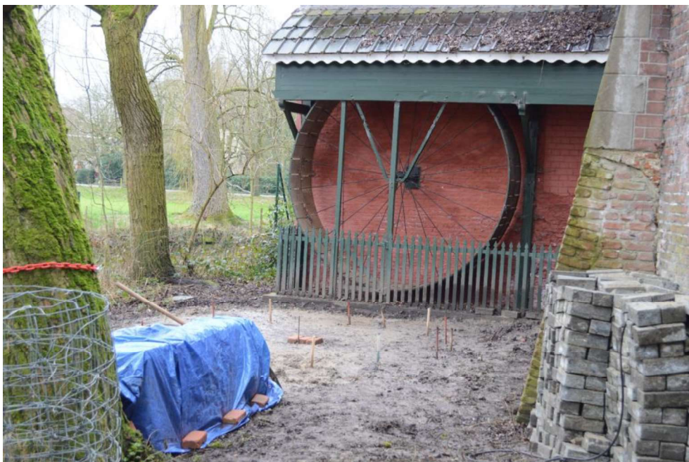
Fig. 103 – Voorbeeld van een hondentredrad op de Heerlijkheid van Heule in Heule (© 2017 Frank Becuwe).
