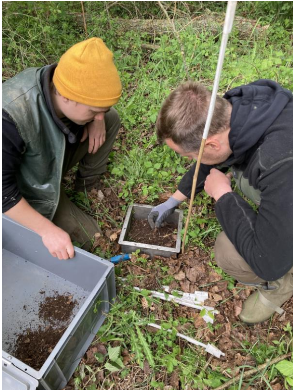
Strooiselstaalname met behulp van de metalen strooiselbak op 1 van de 16 locaties.
