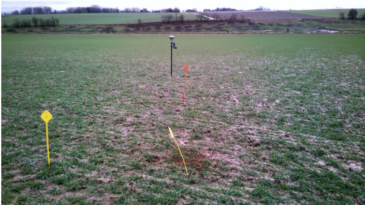
Uitzetten van de staalnamelocaties aan de hand van RTK-GPS
