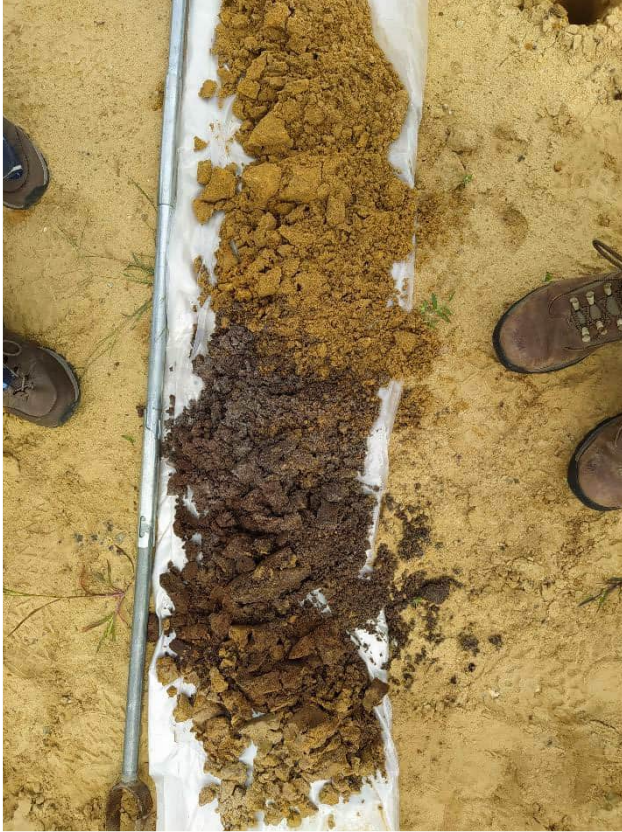
Foto 5: Profiel boring 1 ter hoogte van ontharde zone
