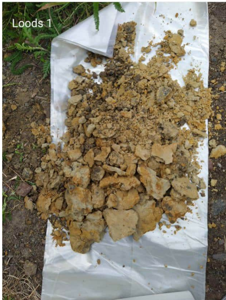
Foto 13 Loods 1 - natuurlijke bodemlaag onder verwijderde kelders, thv B 1
