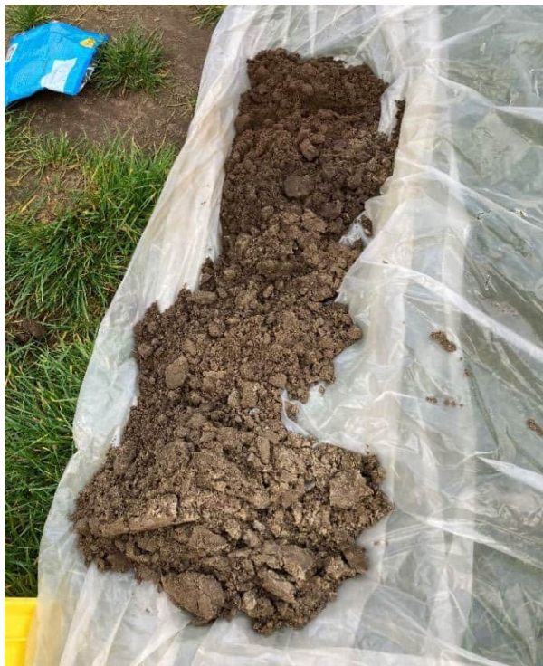
Foto 9 Boorprofiel boring B1 (eerste deel)
