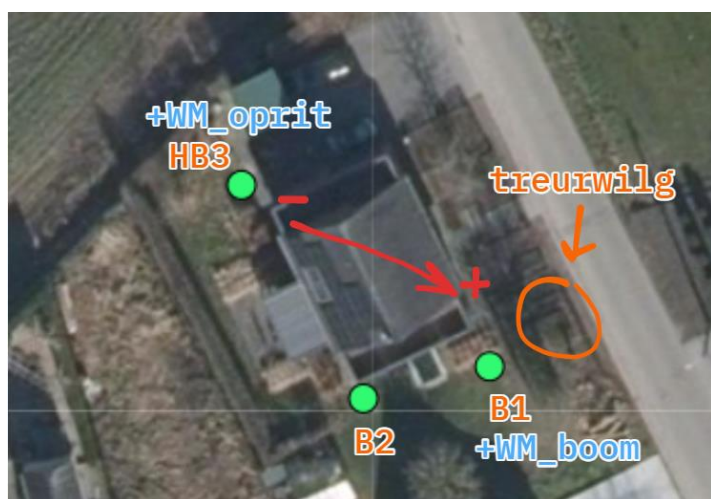
Figuur 33. Situering van case 1 (Ternat): de ligging van de woning, de boringen, de Watermark-sensoren en de treurwilg aan de voorkant van de woning. De 3 sonderingen zijn uitgevoerd in de buurt van de boringen. De richting van de optredende differentiële zetting is aangegeven in het rood.
