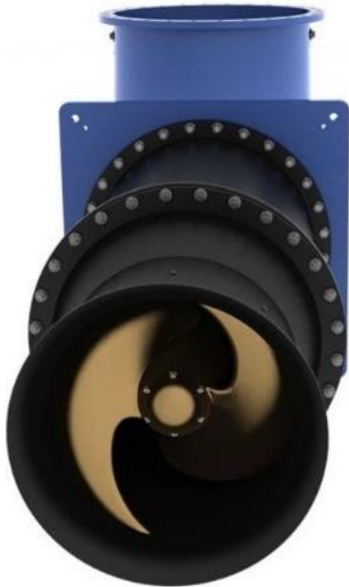
Figuur 10. Een foto van een Fairbank/Nijhuis axiaalpom met visveilige aanpassingen door het reduceren van het aantal bladen naar twee en een grotere opening tussen die twee bladen. Merk op dat dit type pomp enkel visveilig is voor paling.
