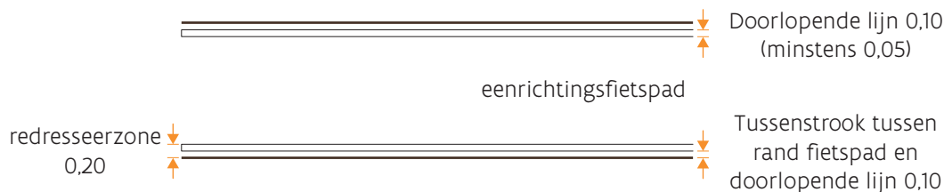
figuur 8: Voorbeeld van toepassing van een randmarkering als onderdeel van de redresseerzone
