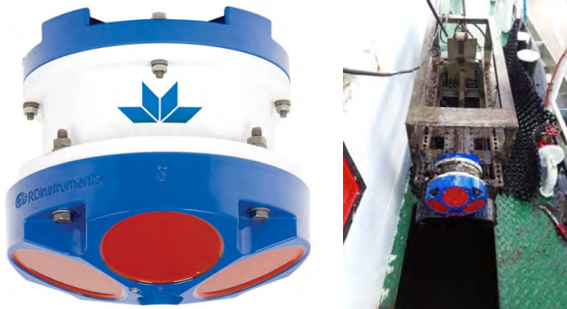
Figuur 3: Gebruikte meettoestellen: ADCP RDI Workhorse Monitor (links) gemonteerd op meetframe in beun Hondius (rechts)
