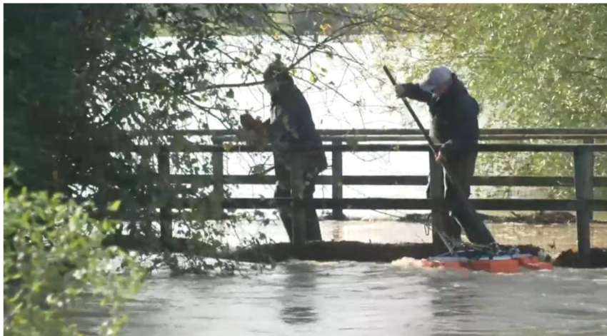
Figuur 17. IJkmeting tijdens volle was op de Dode IJzer op 2023-11-07. Merk op dat nu een nabij gelegen brug gebruikt wordt die zich ongeveer 30 meter opwaarts de brug voor doorgaand verkeer bevindt. Geijkt debiet toen: 20 tot 23 m 3 /s.
