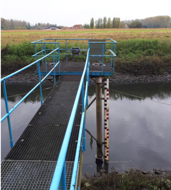
Figuur 63: Tijmeetopstelling te Zemst op de Zenne, met rechts zicht op de radaropstelling
