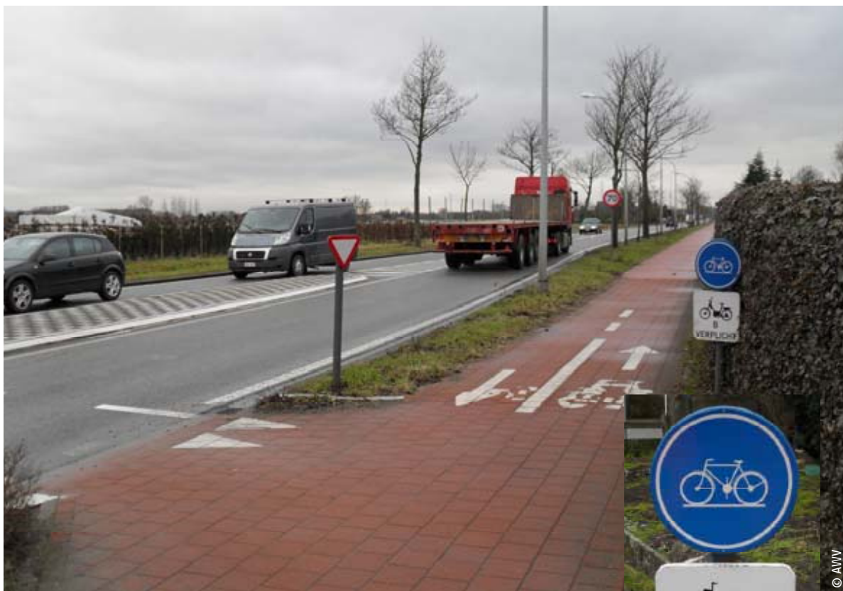
Foto: Fietsers en bromfietsers worden niet van elkaar gescheiden op de Dendermondsesteenweg in Breendonk
