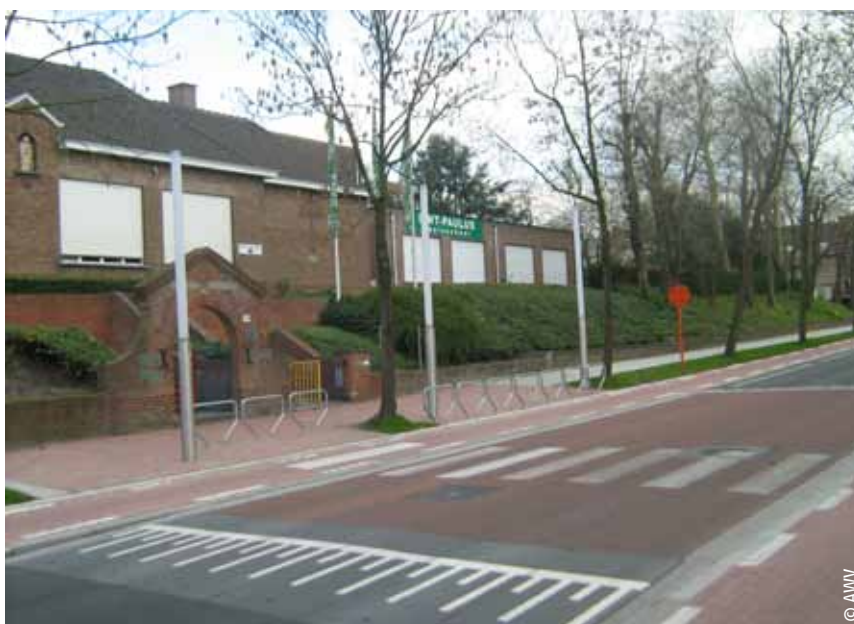
Foto: Naast de schooltoegang is een wachtruimte voorzien die van de rijbaan is afgeschermd met omegaprofielen. (Kortrijk, Burgemeester F. de Bethunelaan)
