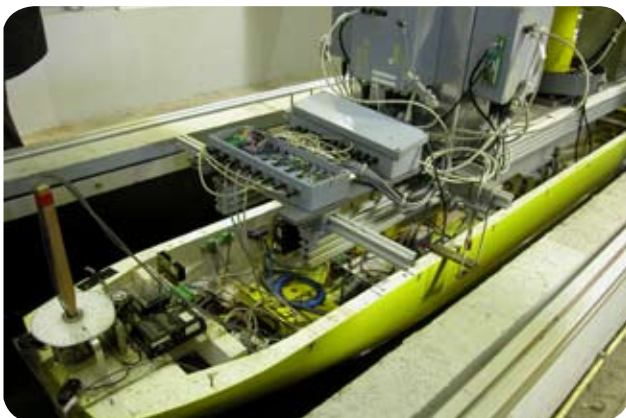
DIOC's voor communicatie met de computer
