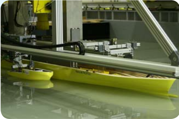
Scheepsinteractieproeven: sleepboot en containerschip
