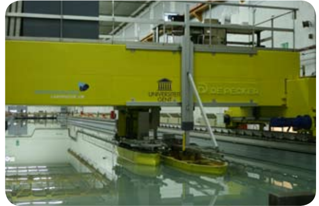
Schip-schip interactieproeven: Aframax en VLCC
