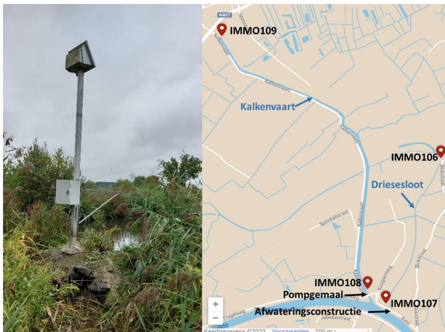
Foto 5: Links: Meetsonde IMMO107 ter hoogte van de afwateringsconstructie van de Driesesloot. Rechts: Kaart met de locaties van de 4 meetsondes die continue de waterkwaliteit monitoren (©Google Maps).
