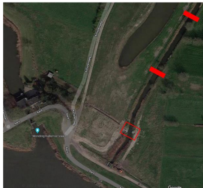
Foto 1: Een luchtfoto van de monding van de Driesesloot in de Zeeschelde (©Google Maps). In het rode vierkant is de val voor wolhandkrabben te zien en de twee rode balken geven de plaats van de eerste twee drempels van de vistrap weer.
