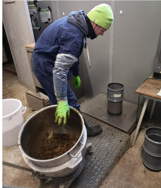
Figuur 28: Vullen van de mestcontainers met 4kg stalmestmengsel.
