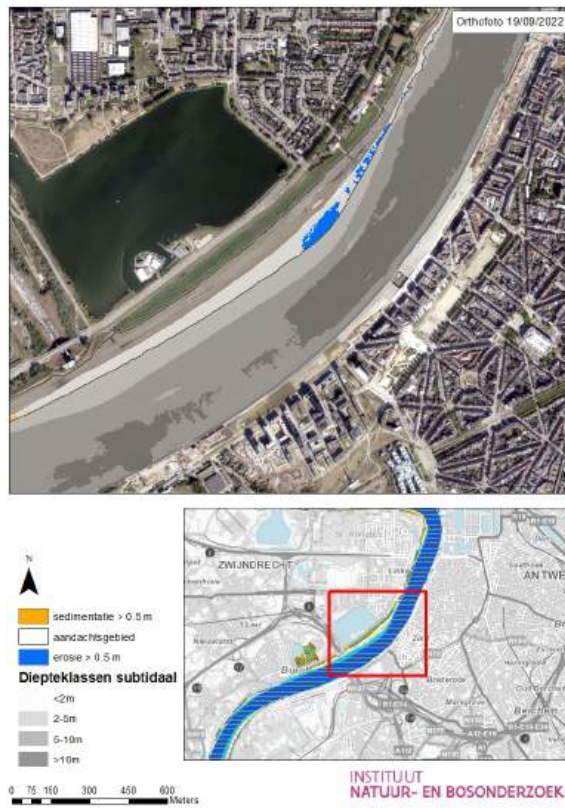
Figuur 14.4: Galgenweel – erosie en sedimentatie (2021/2022 - 2023)
