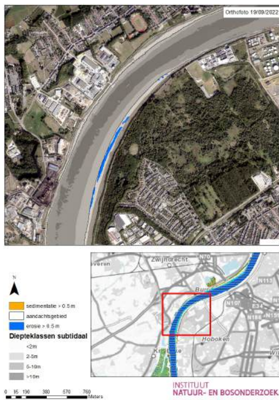
Figuur 14.5: Hoboken – erosieve zone (2022 - 2023)
