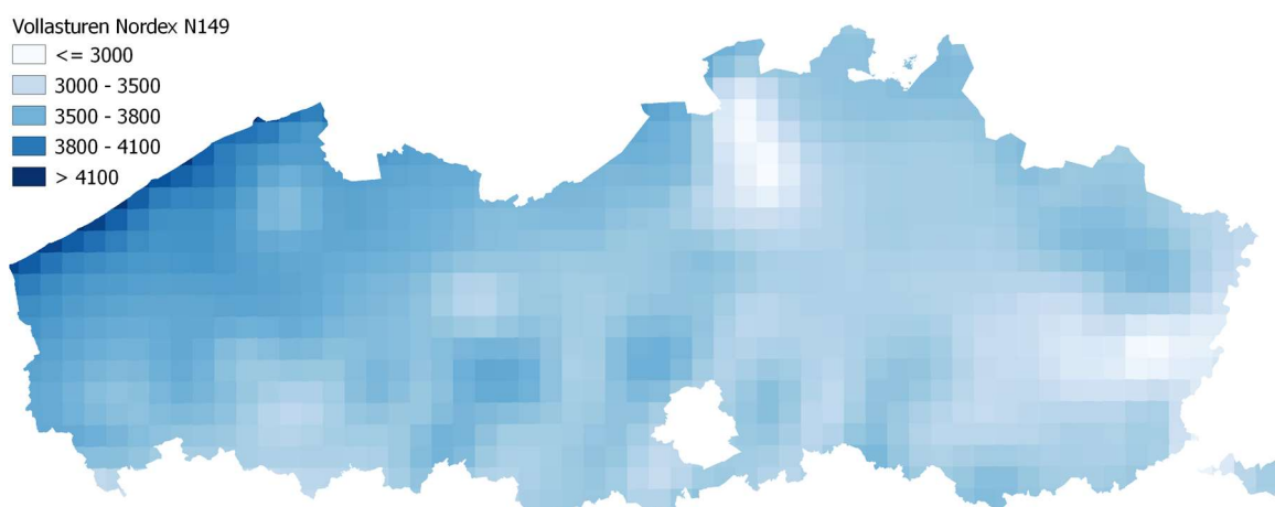
Figuur 4 Vollasturenkaart voor windturbine type Nordex N149 (4.5MW) gebaseerd op klimatologisch jaar 2017 zonder toepassing haalbaarheidsfactor voor prestatieverliezen.
