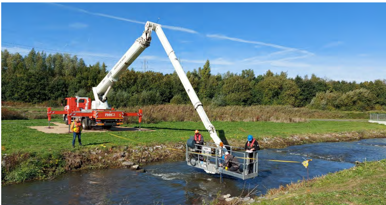
Figuur 11 – Uitvoering snelheidsmeting vanuit platform hoogtewerker
