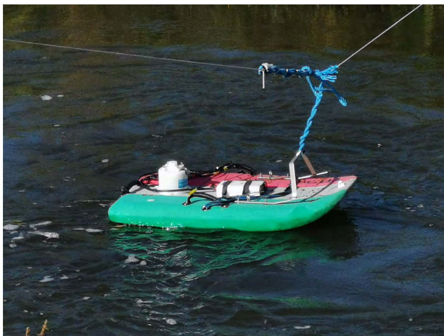
Figuur 9 – Boven: het kabel-katrolsysteem met daaraan de Remote Surface Water Vehicle (RSWV) bevestigd; beneden: RSWV met daarop het aDcp -toestel (witte cilinder achteraan).
