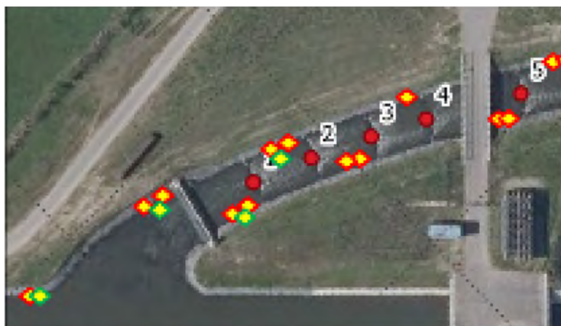
Figuur 42 – Zoom in meetpunten in de instroom en het opwaarts gedeelte van de vispassage
