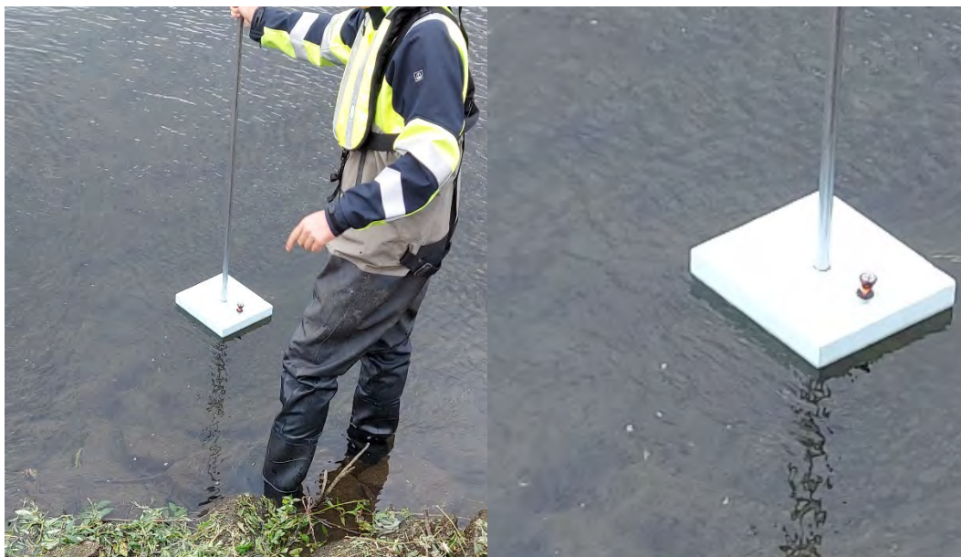
Figuur 8 – Miniprisma gemonteerd op XPS vlotter.
