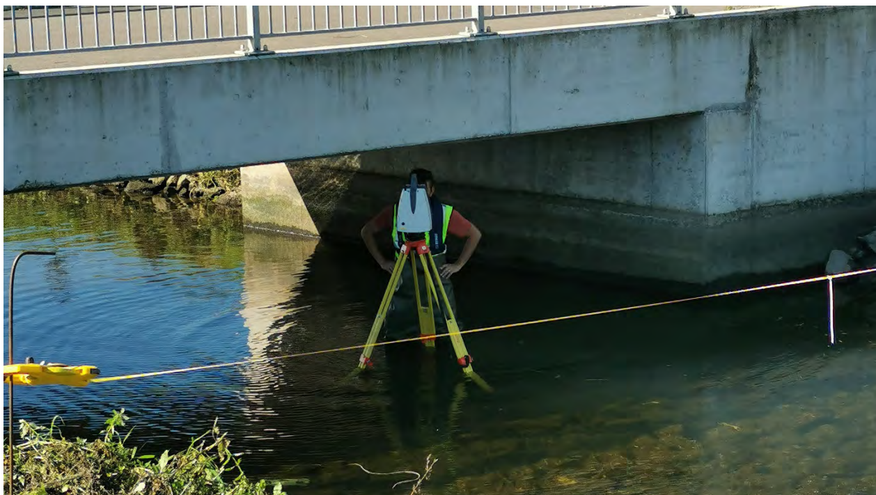
Figuur 4 – Opstelling 3D LiDAR in vispassage.
