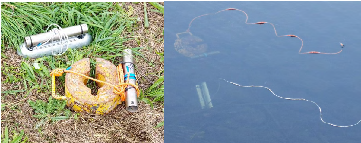
Figuur 7 – Plaatsing Divers aan ballastblok.
