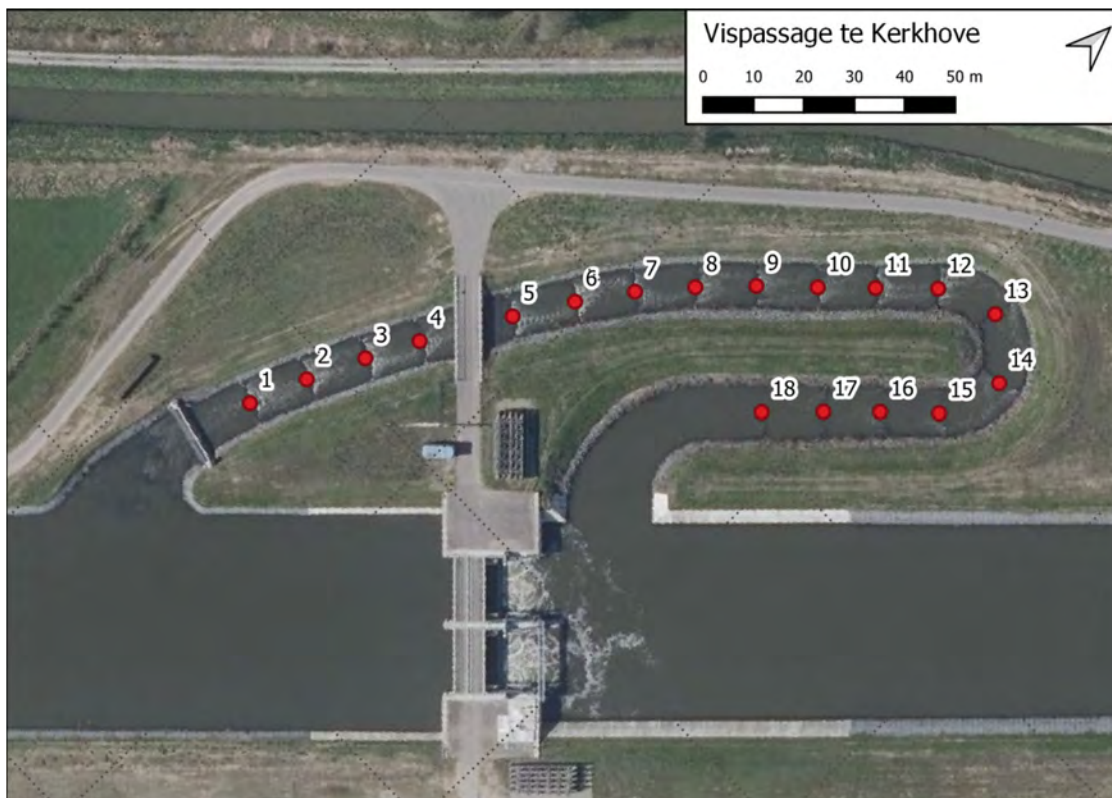
Figuur 2 – Detailbeeld van de vispassage in het sluiscomplex te Kerkhove. De symbolen en cijfers duiden de drempels aan.
